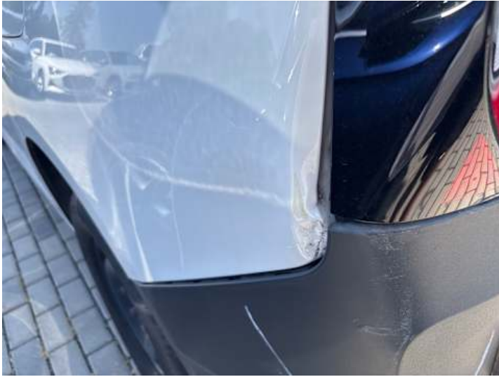
Seitenteil hinten links (Verformung, Kratzer)
