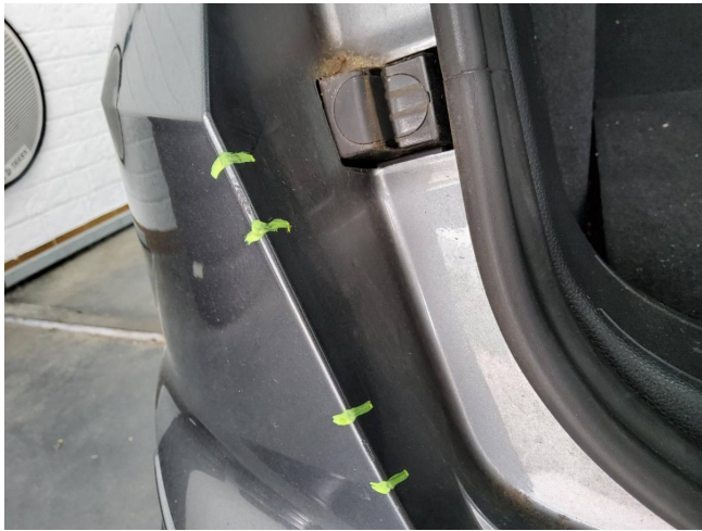
Stoßfänger hinten Lackierung, verschrammt, lackieren mit Lackaufbau (DEKRA)
