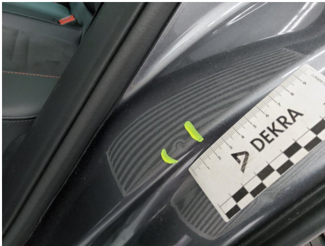
Tür hinten links Einstieg, eingedellt, smart repair (DEKRA)
