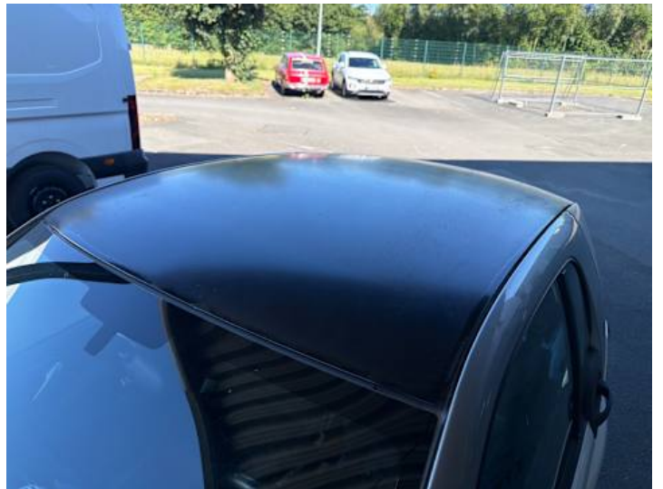
Dach (Anderer Schaden): Matt
