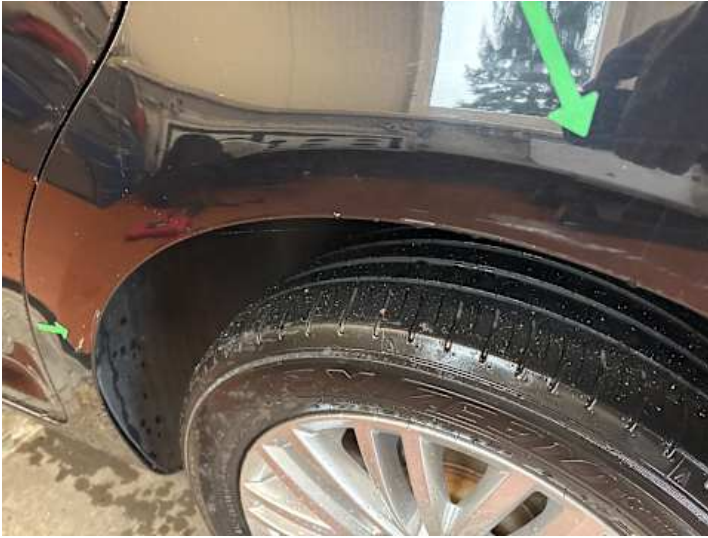
Seitenteil hinten links (Kratzer, Delle)
