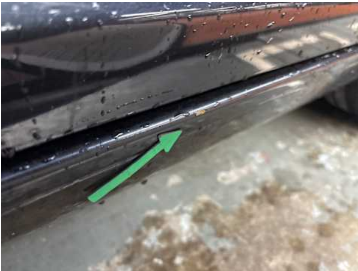
Schweller rechts (Rost)
