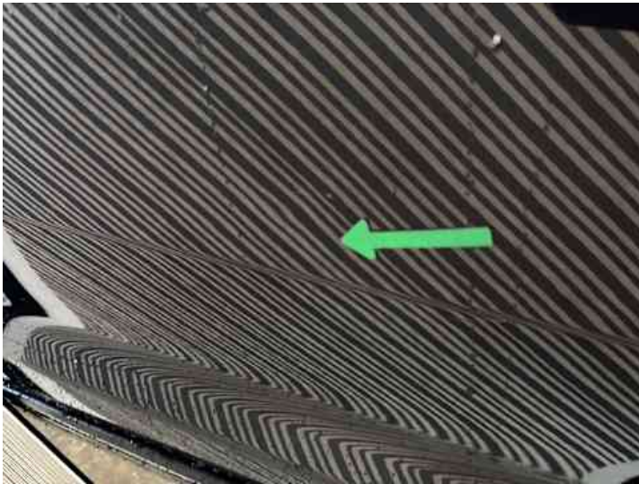
Türe hinten rechts (Delle, Kratzer)
