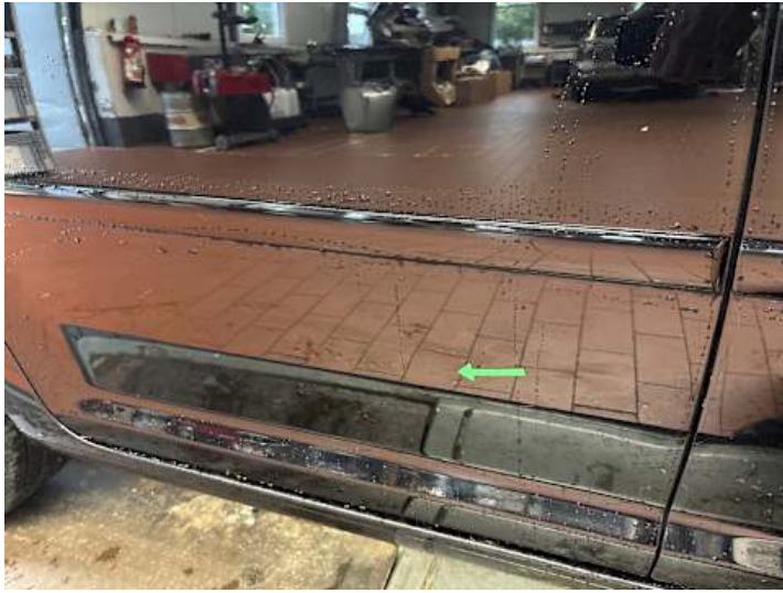
Türe hinten rechts (Delle, Kratzer)
