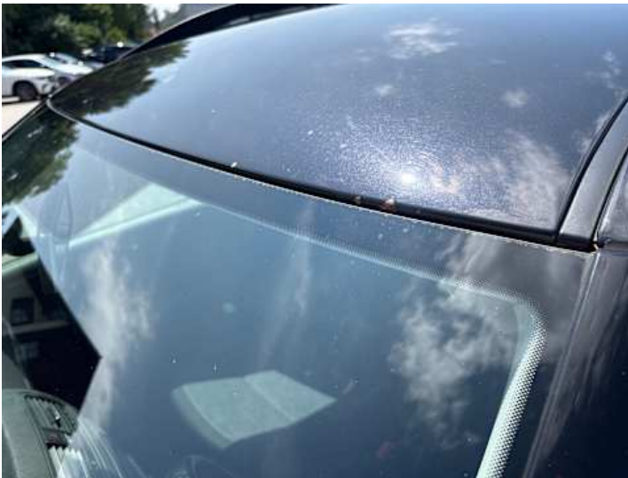
Dach (Steinschlag, Rost, Lackschaden)
