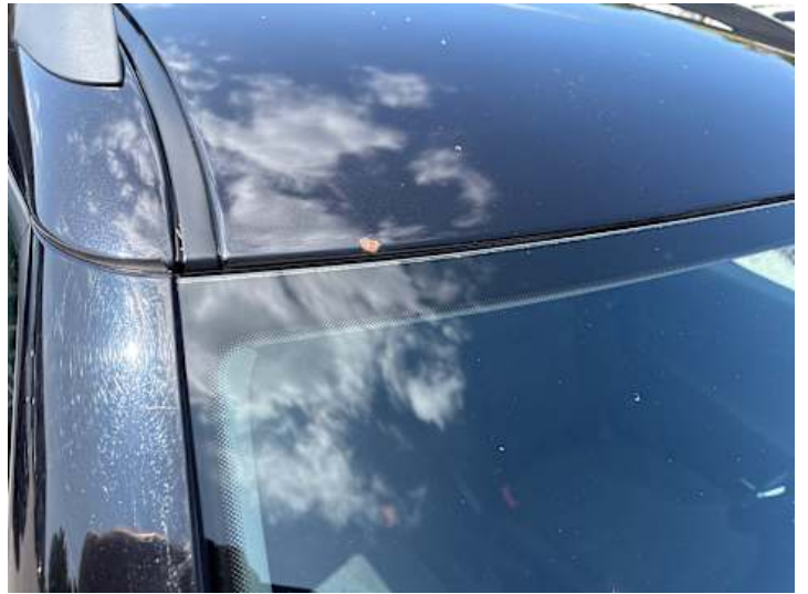
Dach (Steinschlag, Rost, Lackschaden)
