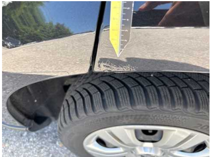
Seitenteil hinten links (Rost, Lackschaden)
