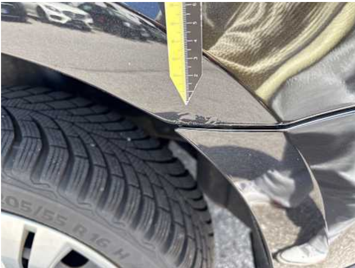
Seitenteil hinten links (Rost, Lackschaden)
