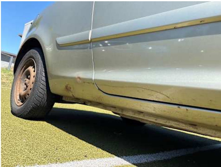
Schweller rechts (Rost, Verformung)
