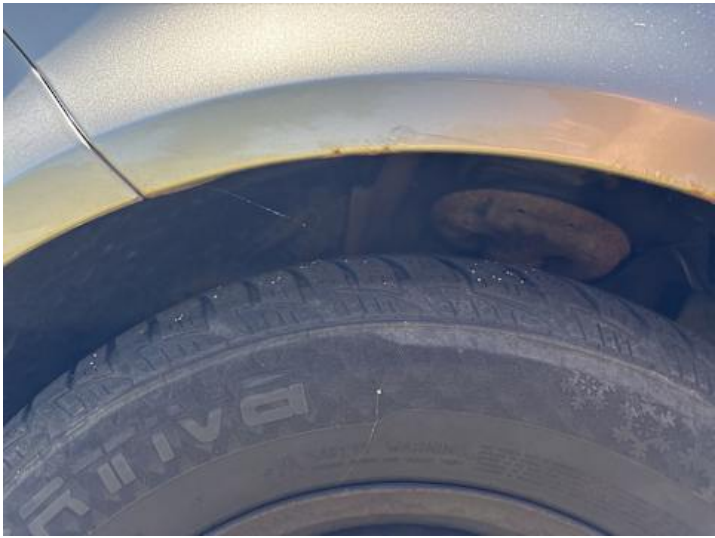
Kotflügel vorne links (Rost)
