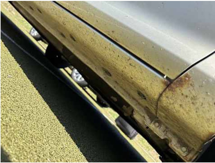
Schweller rechts (Rost, Verformung)
