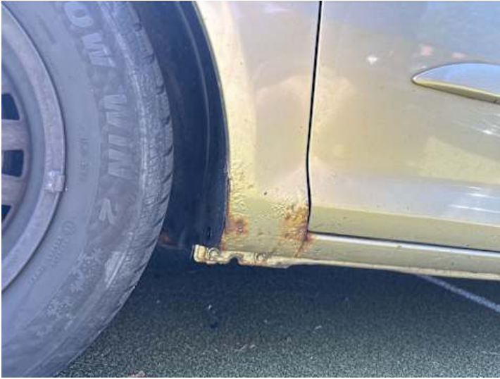
Kotflügel vorne links (Rost)
