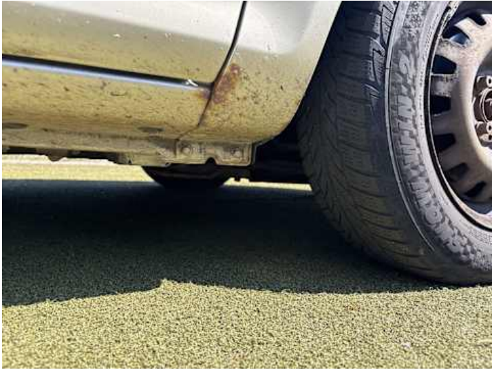
Kotflügel vorne rechts (Rost)
