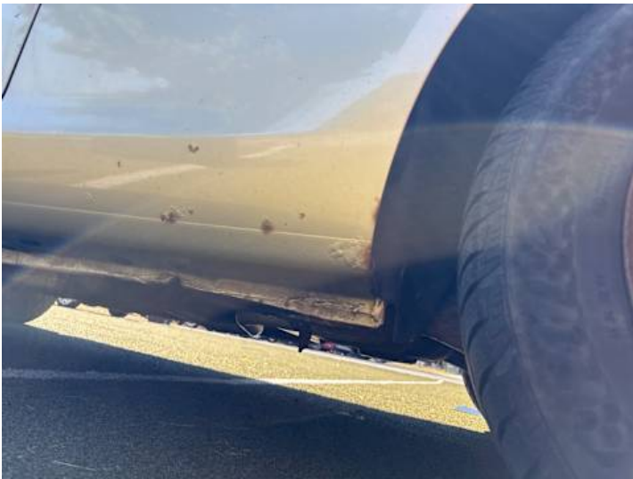
Schweller links (Rost)
