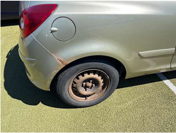
Seitenteil hinten rechts (Rost)
