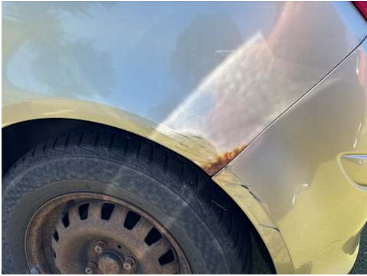
Seitenteil hinten links (Rost, Verformung)
