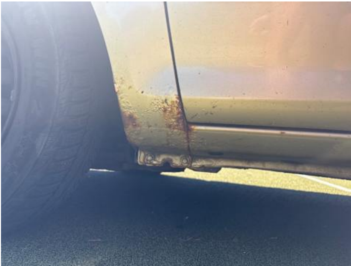
Schweller links (Rost)
