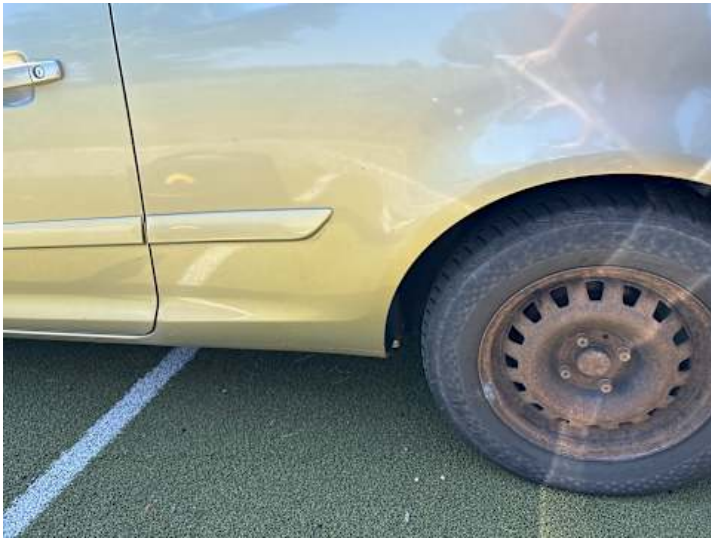
Schweller links (Rost)
