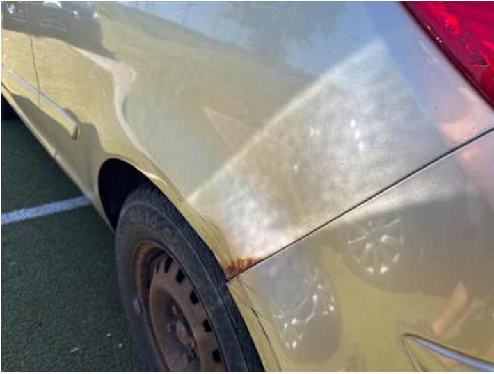
Seitenteil hinten links (Rost, Verformung)
