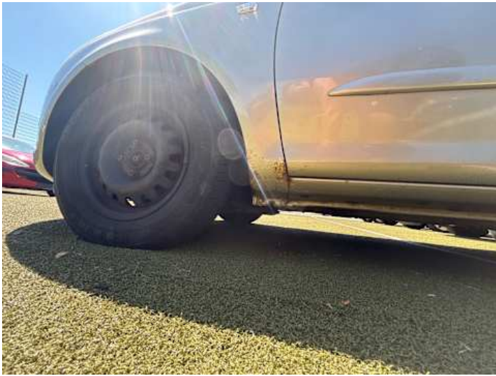
Schweller links (Rost)
