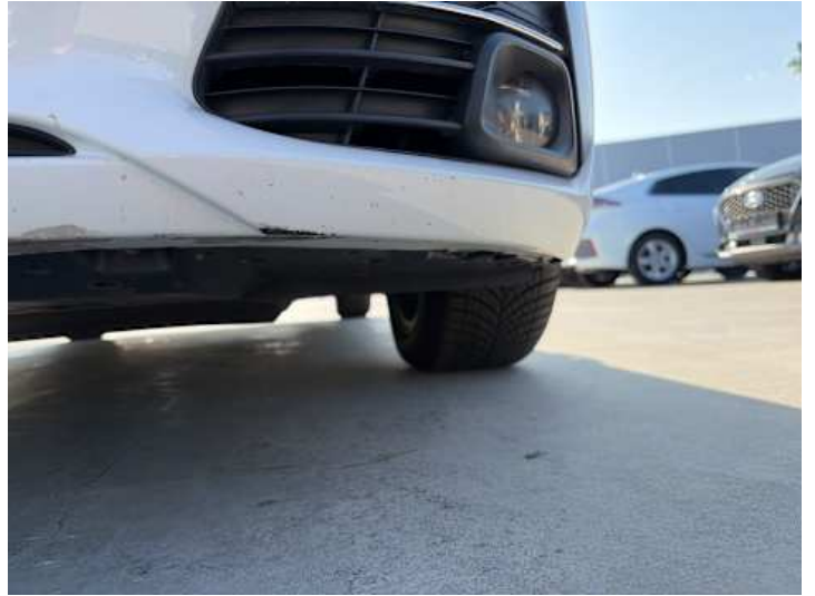
Stoßstange vorne (Kratzer, Lackschaden)
