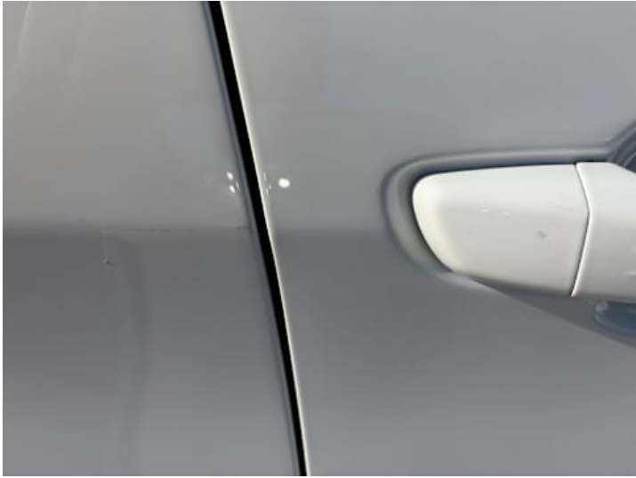
Türe hinten rechts (Kratzer, Lackscha­den)
