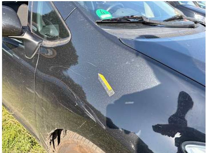
Kotflügel vorne rechts (Kratzer, Delle)
