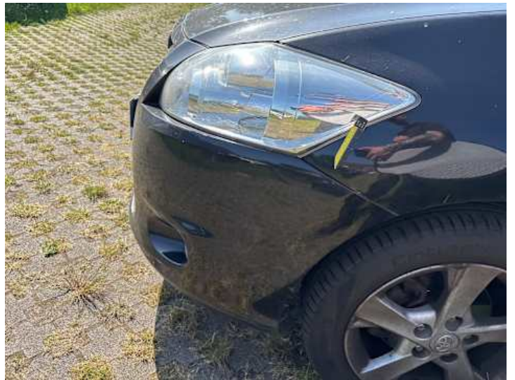
Stoßstange vorne (Spaltmaße ungenau)
