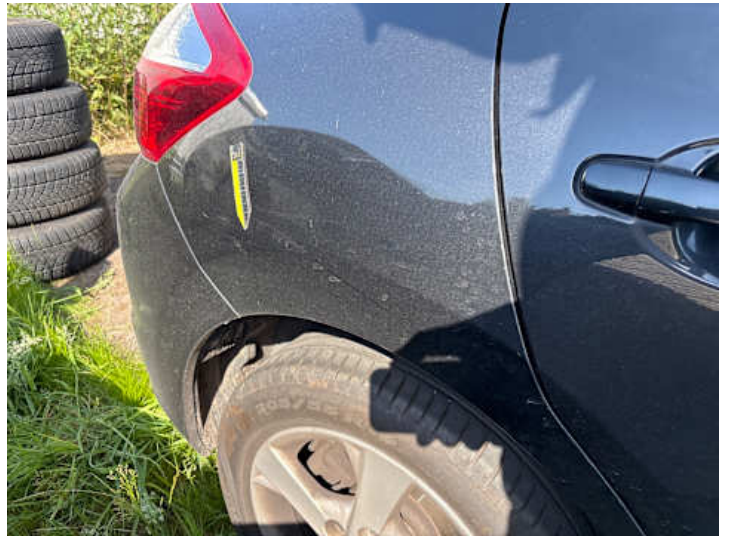
Seitenteil hinten rechts (Delle)
