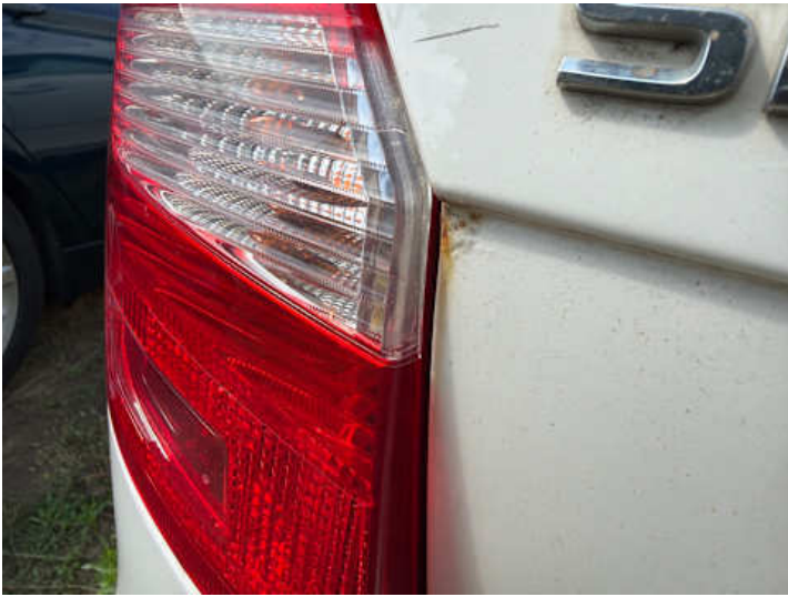
Heckklappe (Anderer Schaden, Rost): Klebereste
