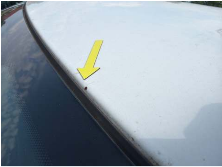
Dach (Lackschaden, Rost)
