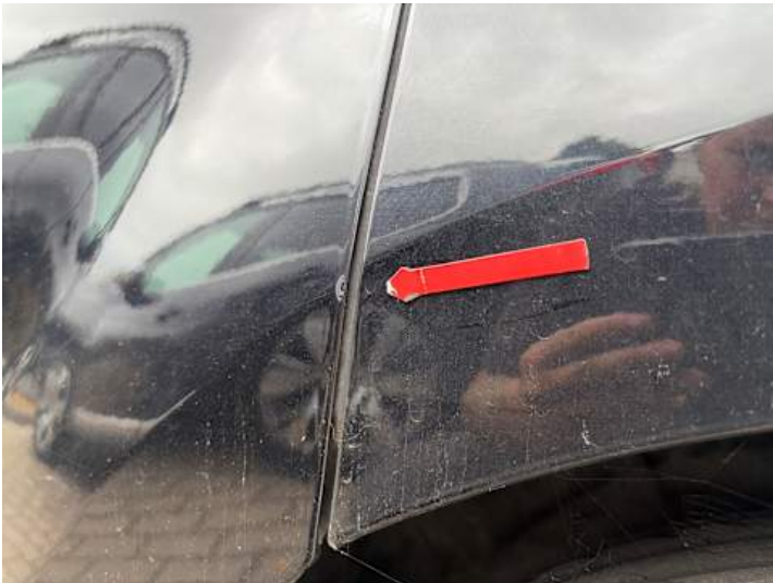
Türe hinten links (Lackschaden)
