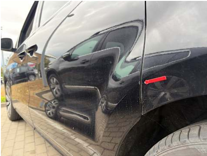
Türe hinten links (Lackschaden)
