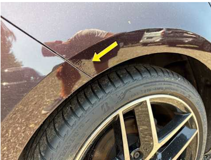
Seitenteil hinten rechts (Rost)
