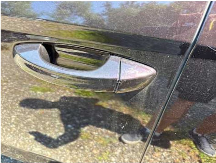
Fahrtür (Unsachgemäß instand gesetzt)
