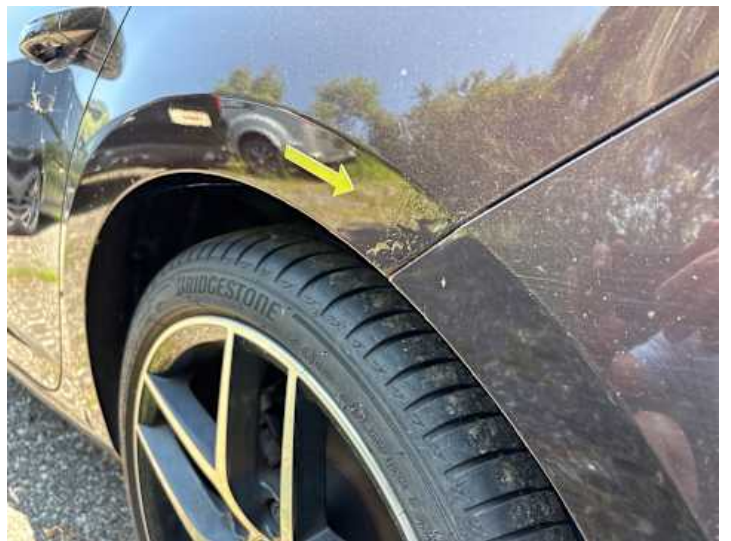
Seitenteil hinten links (Rost)
