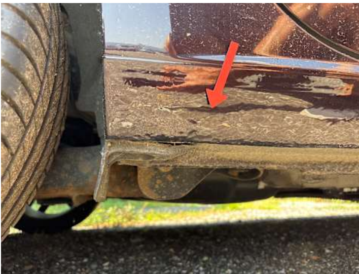
Schweller rechts (Unsachgemäß instand gesetzt, Rost)
