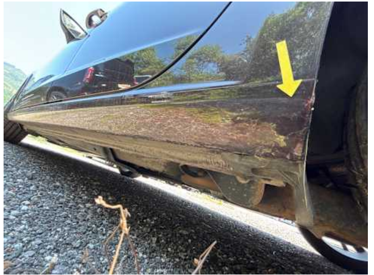
Schweller links (Rost)
