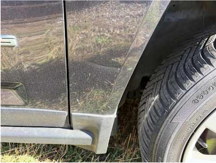
Kotflügel vorne rechts (Kratzer, Lackschaden, Delle)
