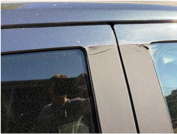
Türe hinten rechts (Riss/Bruch)
