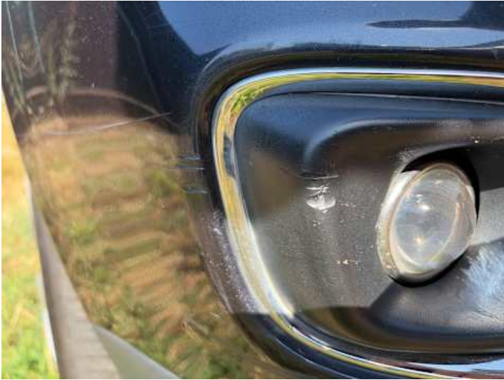
Stoßstange vorne (Spaltmaße ungenau, Kratzer, Lackschaden)
