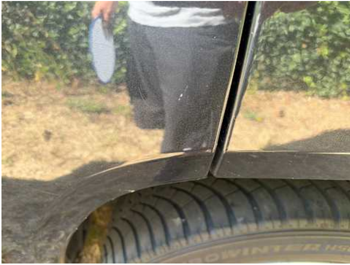
Türe hinten links (Kratzer, Lackschaden)
