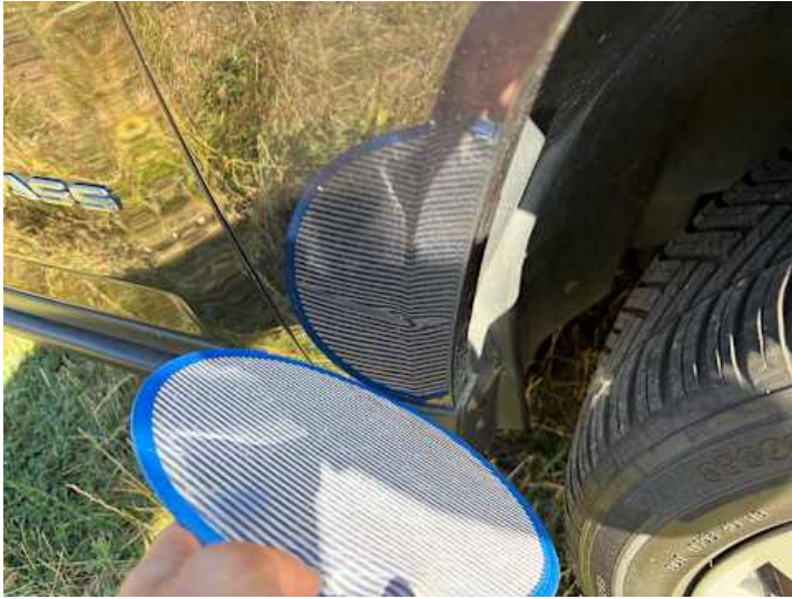
Kotflügel vorne rechts (Kratzer, Lackschaden, Delle)
