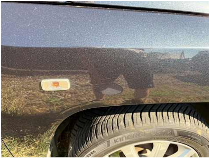
Kotflügel vorne rechts (Kratzer, Lackschaden, Delle)
