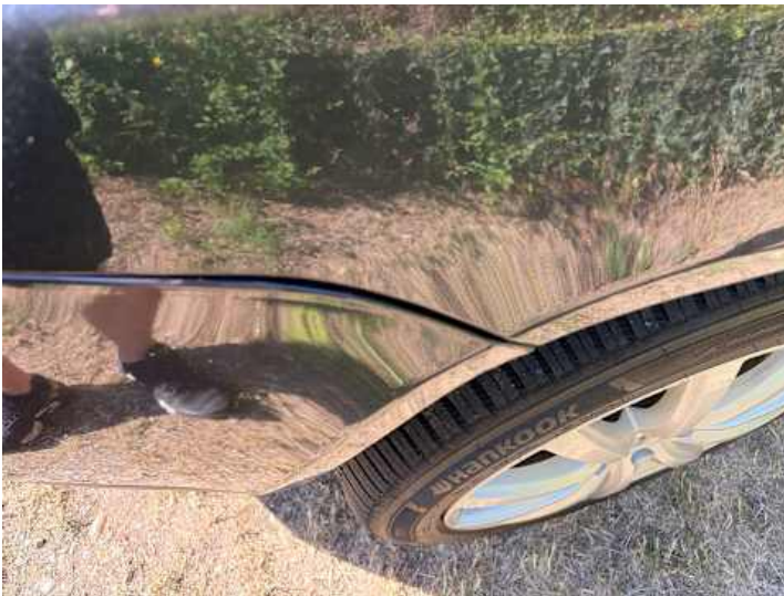
Stoßstange vorne (Spaltmaße ungenau, Kratzer, Lackschaden)
