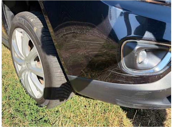
Stoßstange vorne (Spaltmaße ungenau, Kratzer, Lackschaden)
