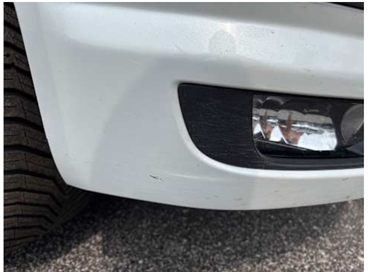
Stoßstange vorne (Kratzer, Unsachgemäß instand gesetzt)
