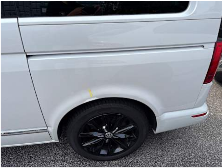
Seitenteil hinten links (Unsachgemäß instand gesetzt)
