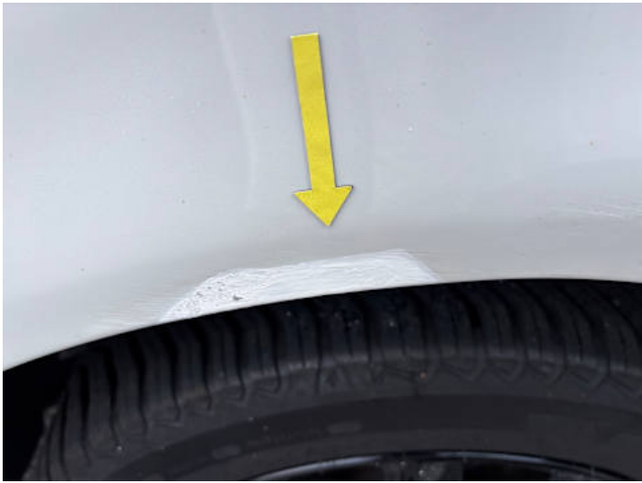
Seitenteil hinten links (Unsachgemäß instand gesetzt)
