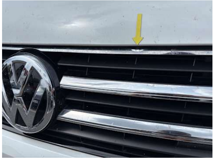
Stoßstange vorne (Lackschaden)
