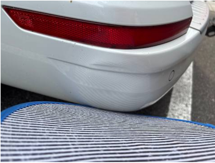
Stoßstange hinten (Verformung)
