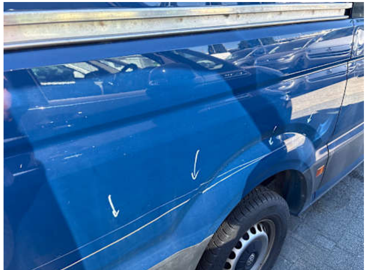
Seitenteil hinten rechts (Lackschaden, Delle)
