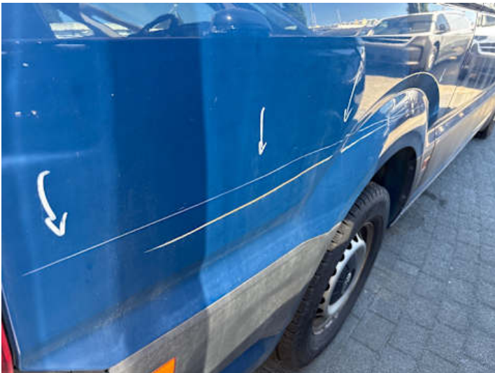
Seitenteil hinten rechts (Lackschaden, Delle)
