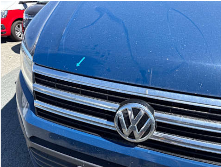
Motorhaube (Steinschlag, Rost)
