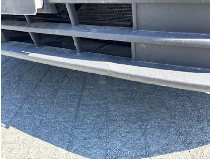
Stoßstange vorne (Kratzer, Lackschaden, Verformung)
