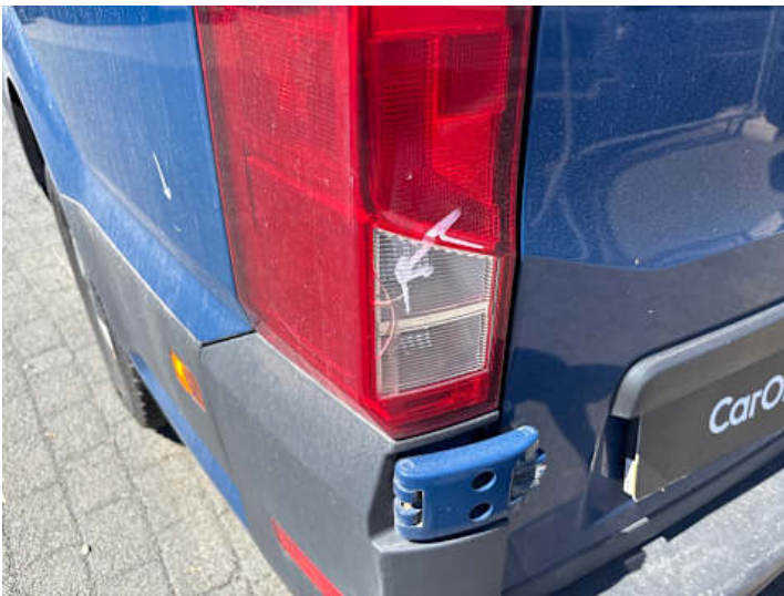
Rücklicht (links) (Riss/Bruch)
