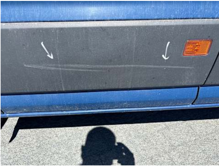
Fahrradtür (Delle, Kratzer)
