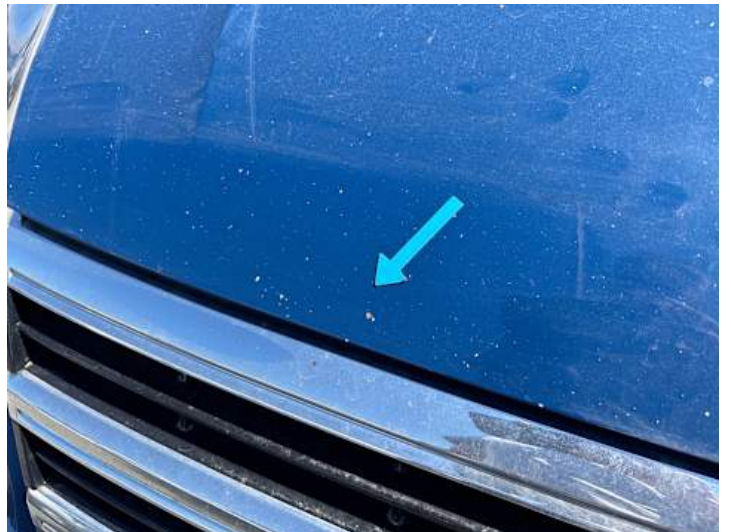
Motorhaube (Steinschlag, Rost)
