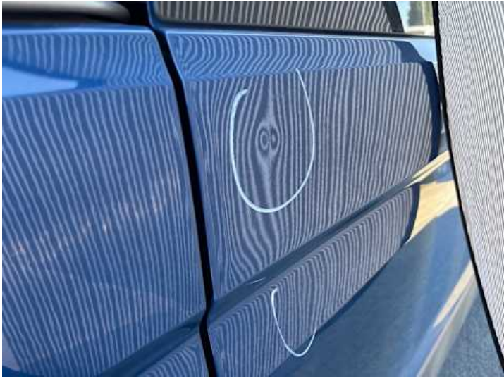
Türe hinten rechts (Delle)
