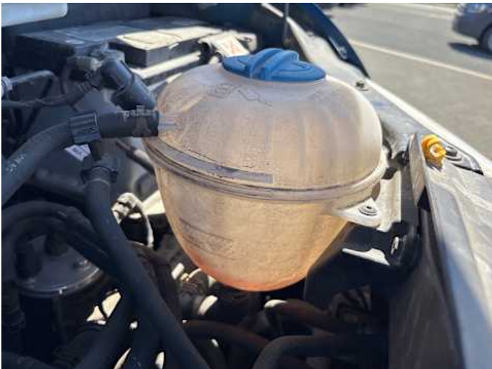
Motorhaube (Anderer Schaden): Kühlmittelstand zu gering,
