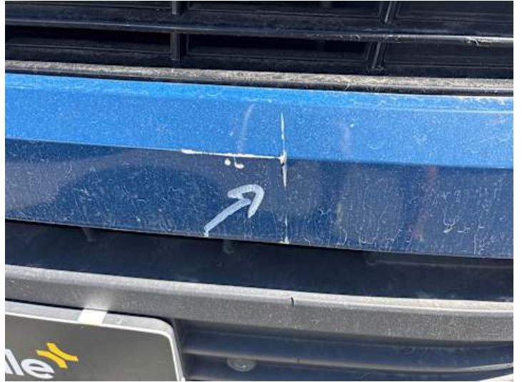
Stoßstange vorne (Kratzer, Lackschaden, Verformung)
