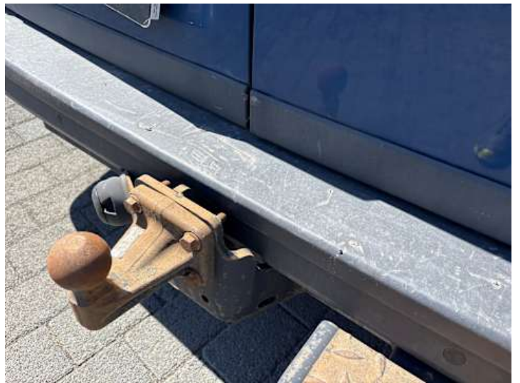
Stoßstange hinten (Kratzer)
