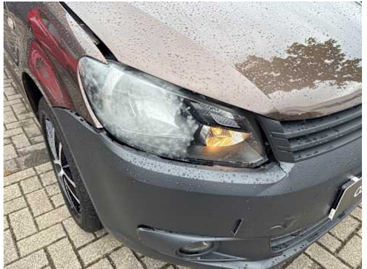
Scheinwerfer (rechts) (Riss/Bruch, Undicht)
