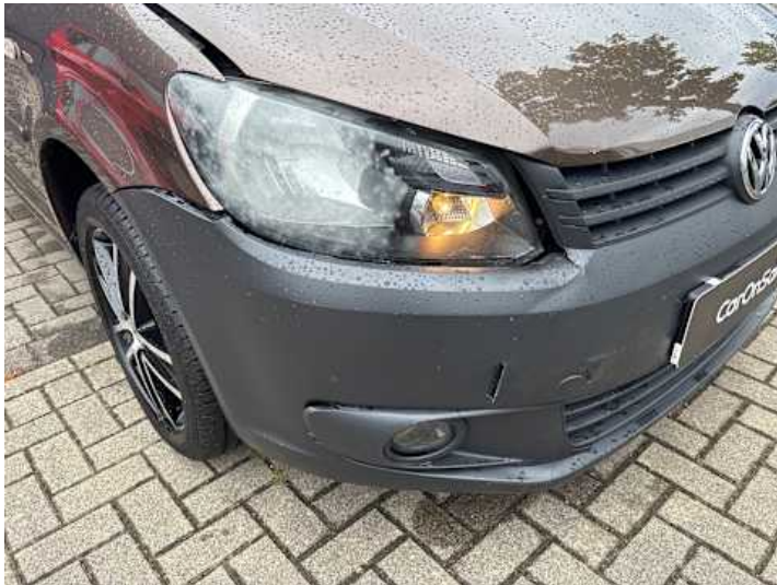
Stoßstange vorne (Spaltmaße ungenau, Verformung, Riss/Bruch)
