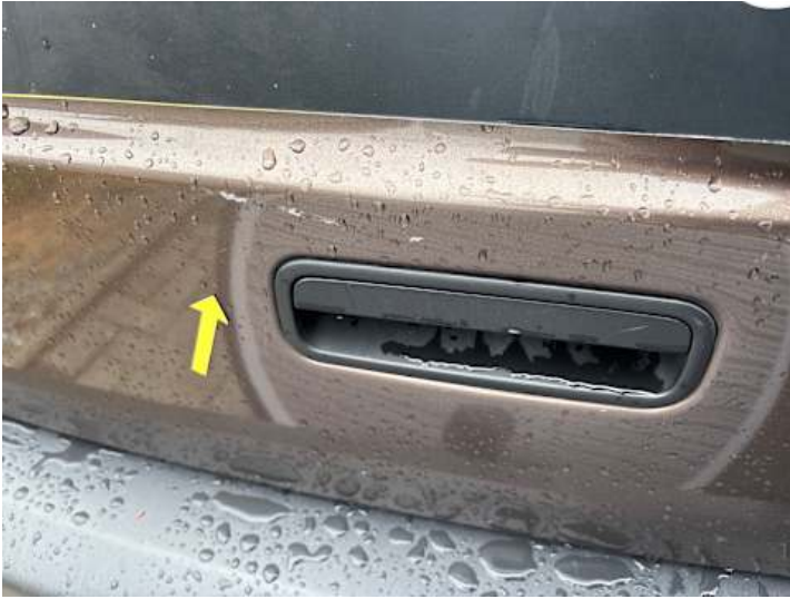
Heckklappe (Kratzer, Lackschaden)
