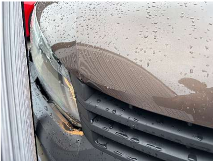
Motorhaube (Spaltmaße ungenau, Verformung, Kratzer)
