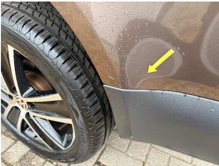
Seitenteil hinten links (Kratzer)
