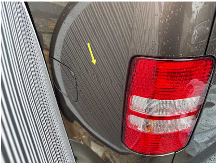
Seitenteil hinten links (Verformung, Kratzer)
