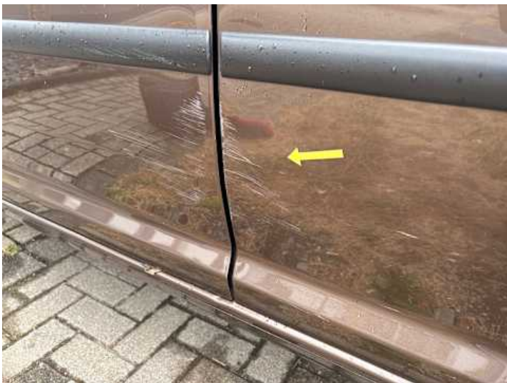
Seitenteil hinten links (Verformung, Kratzer)
