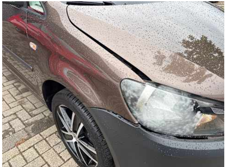
Kotflügel vorne rechts (Spaltmaße ungenau, Verformung)
