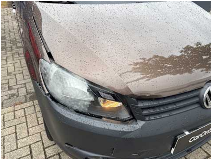
Motorhaube (Spaltmaße ungenau, Verformung, Kratzer)
