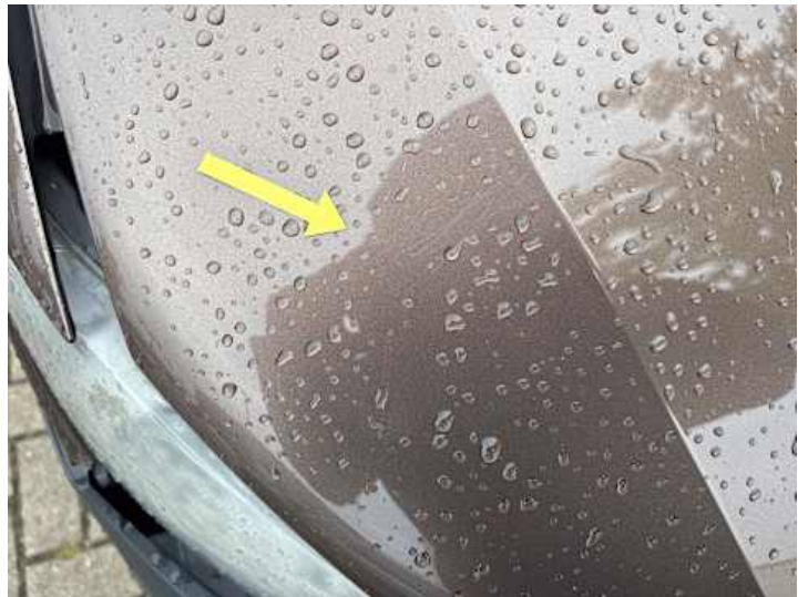
Motorhaube (Spaltmaße ungenau, Verformung, Kratzer)
