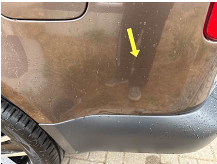
Seitenteil hinten links (Kratzer)
