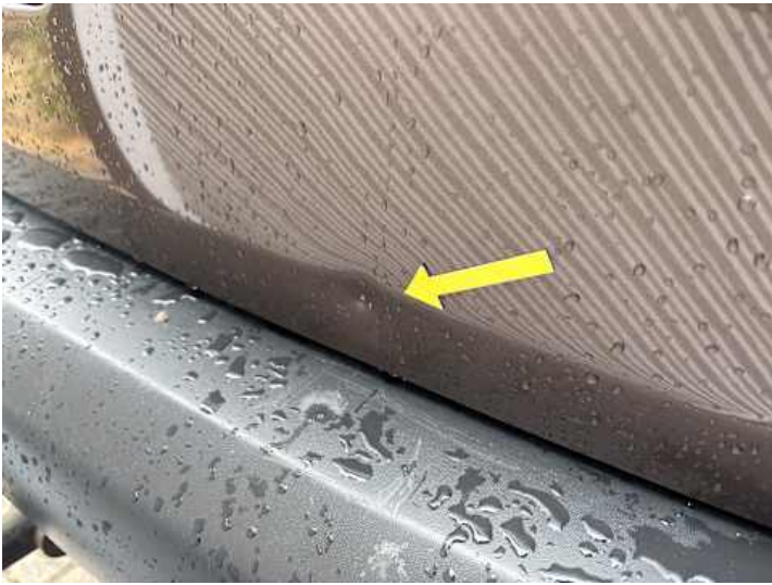
Heckklappe (Delle, Kratzer)
