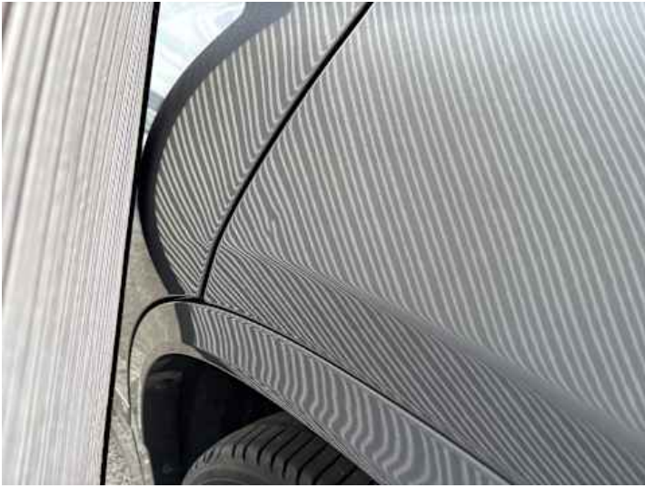
Seitenteil hinten links (Delle)
