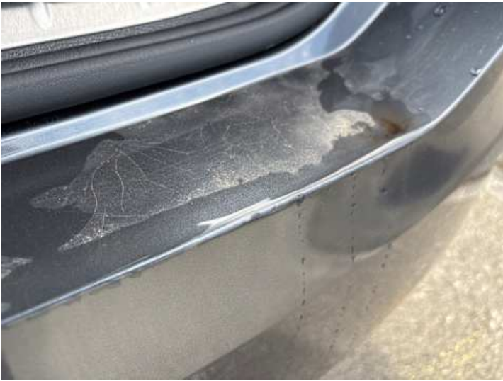
Stoßstange hinten (Kratzer)
