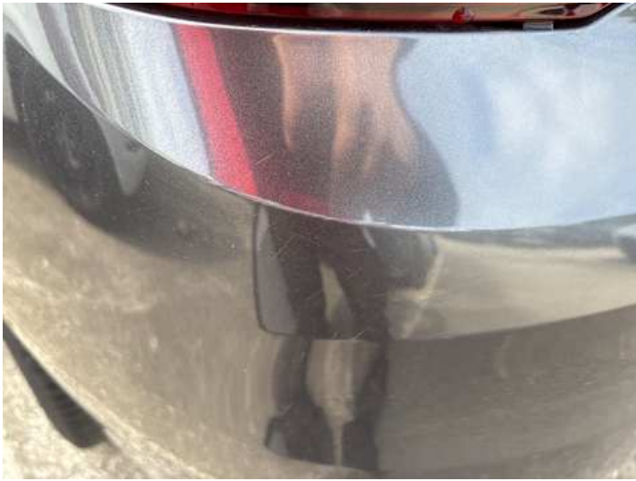
Stoßstange hinten (Kratzer)
