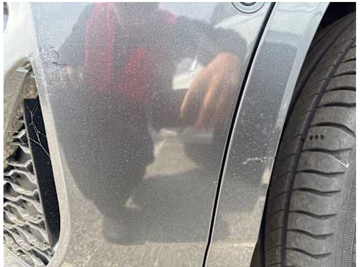
Stoßstange vorne (Kratzer, Lackschaden)
