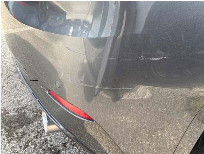
Stoßstange hinten (Kratzer)
