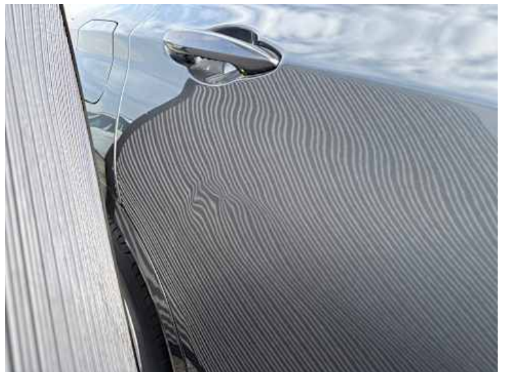
Türe hinten rechts (Verformung)
