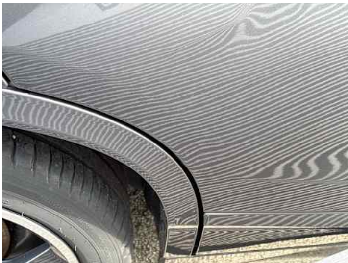
Türe hinten rechts (Verformung)
