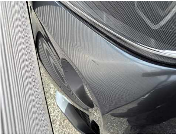
Stoßstange vorne (Verformung)
