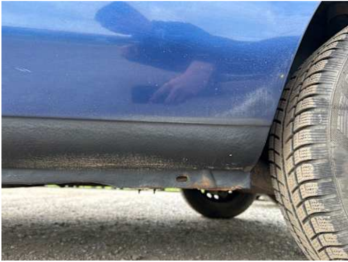
Schweller links (Rost)
