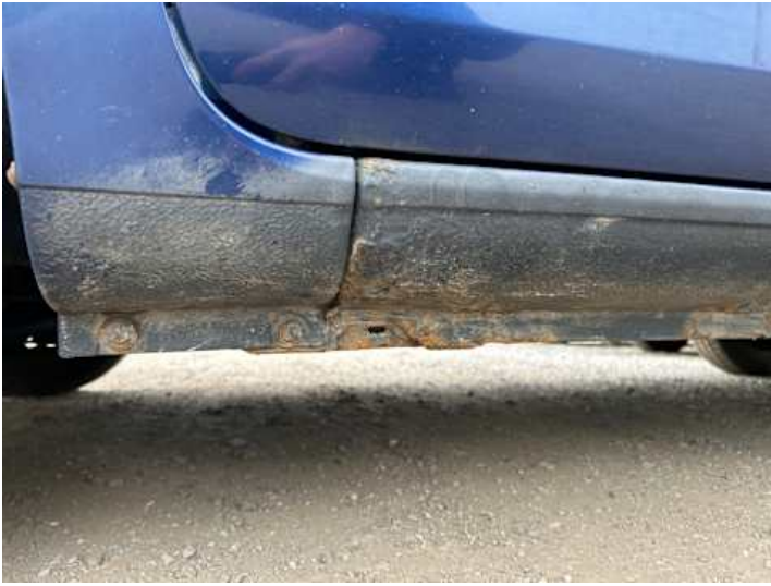
Schweller links (Rost)
