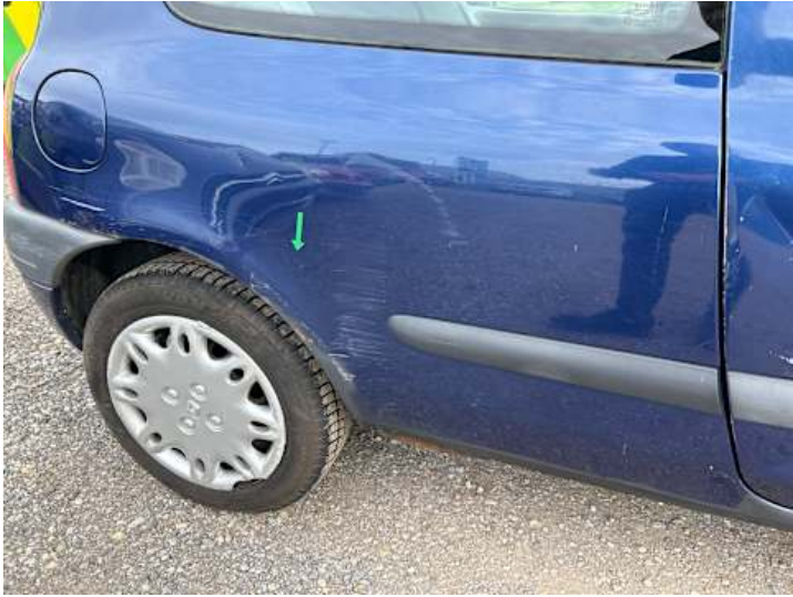
Seitenteil hinten rechts (Rost, Lackschaden, Kratzer)
