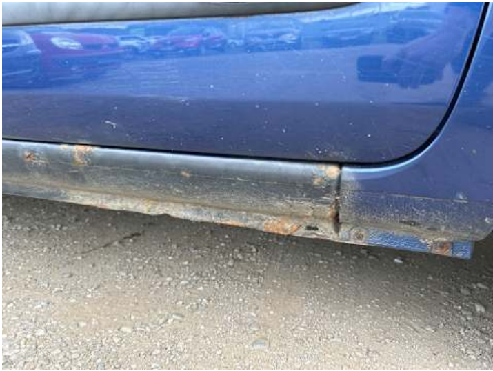
Schweller rechts (Rost)
