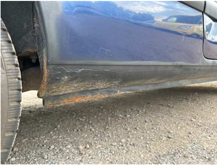
Schweller rechts (Rost)
