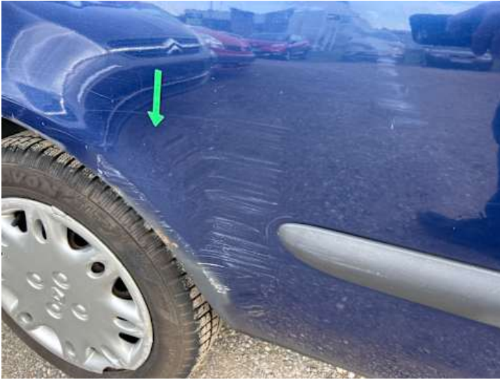
Seitenteil hinten rechts (Rost, Lackschaden, Kratzer)
