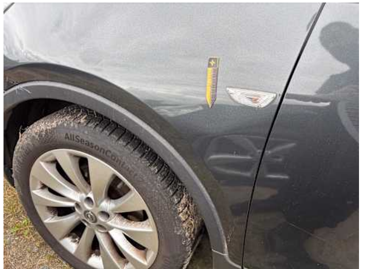
Kotflügel vorne links (Verformung)
