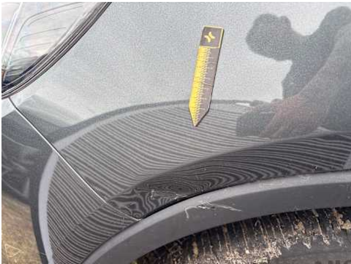
Kotflügel vorne links (Verformung)
