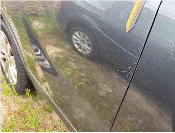
Türe hinten rechts (Kratzer)
