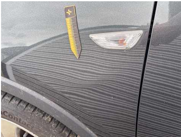
Kotflügel vorne links (Verformung)
