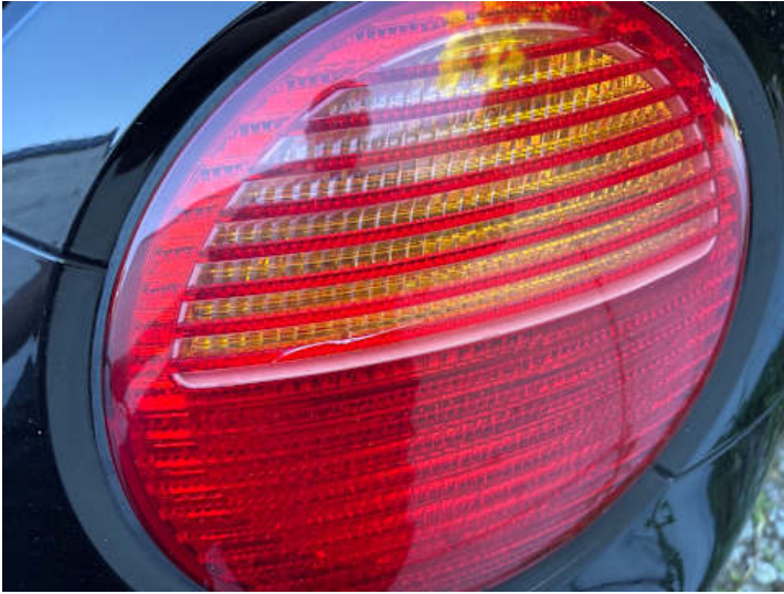
Rücklicht (rechts) (Riss/Bruch)
