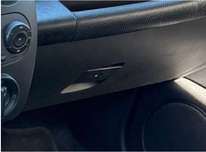
Innenraum (Anderer Schaden): Griff vom Handschuhfach ist gebrochen
