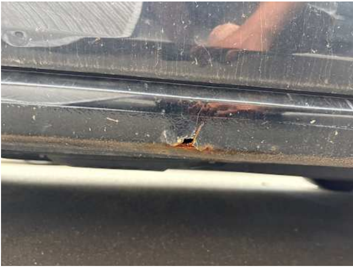
Schweller rechts (Rost)
