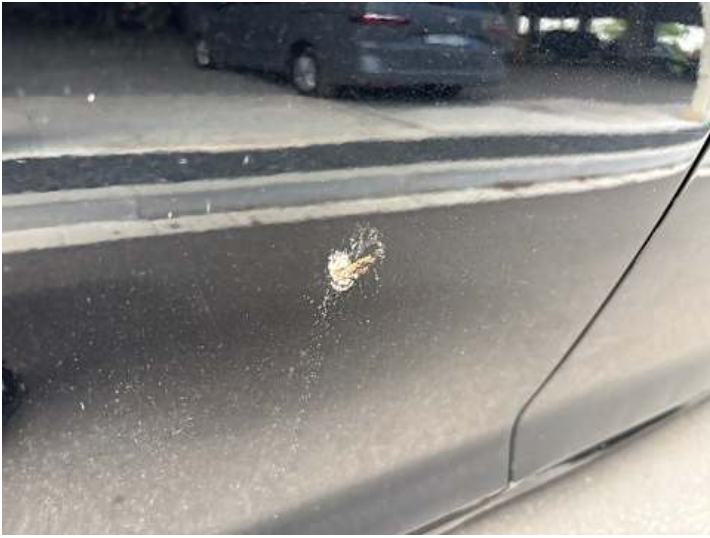
Seitenteil hinten rechts (Lackschaden)
