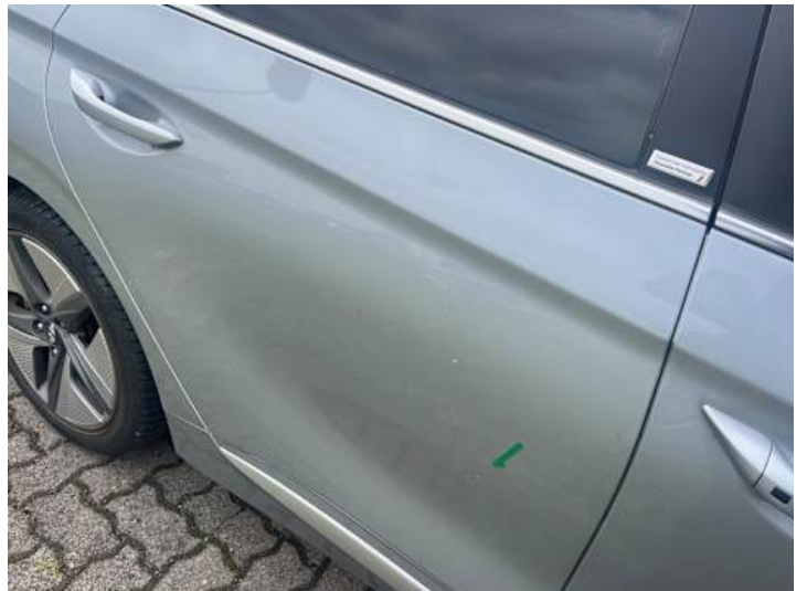
Türe hinten rechts (Delle)
