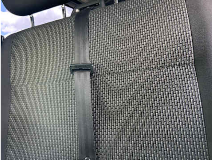
Innenraum (Anderer Schaden): Verdreht
