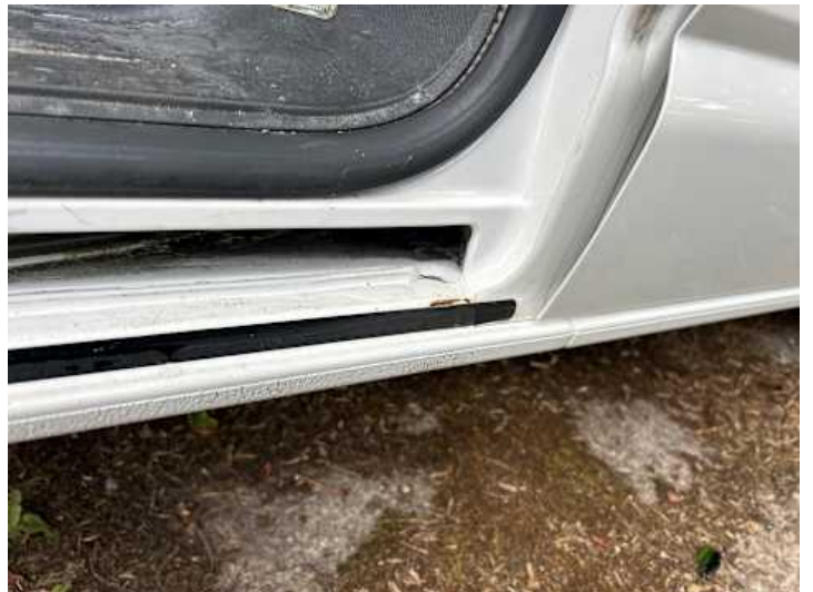
Schweller rechts (Rost)
