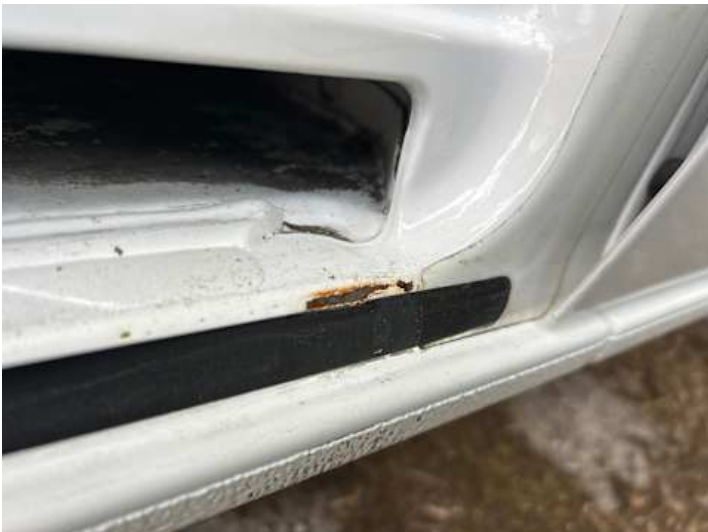
Schweller rechts (Rost)
