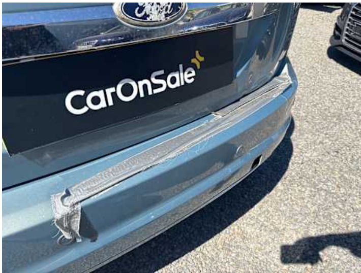
Stoßstange hinten (Unsachgemäß instand gesetzt)
