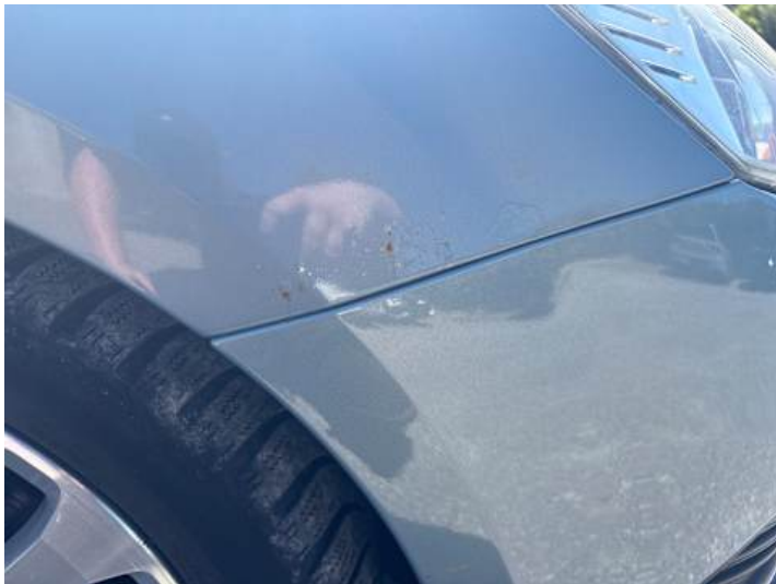
Kotflügel vorne rechts (Rost)
