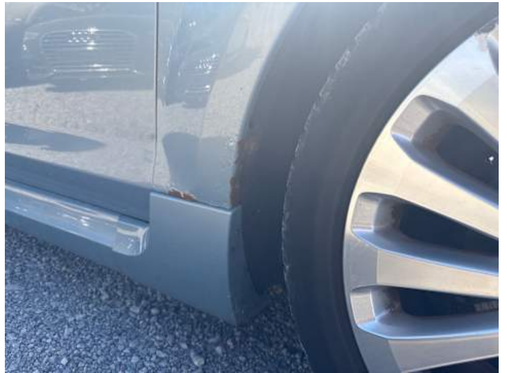
Kotflügel vorne rechts (Rost)
