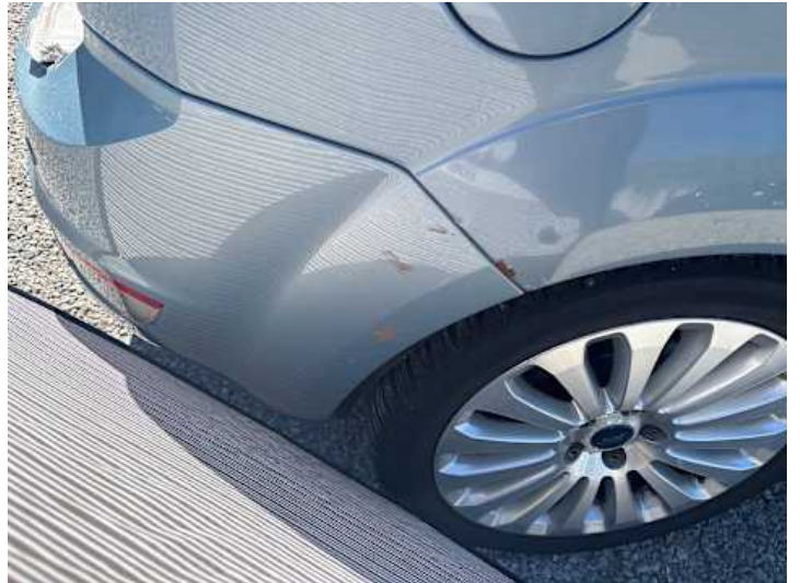
Stoßstange hinten (Kratzer, Verformung)
