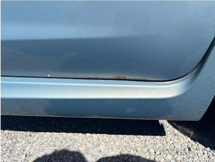
Türe hinten links (Rost)
