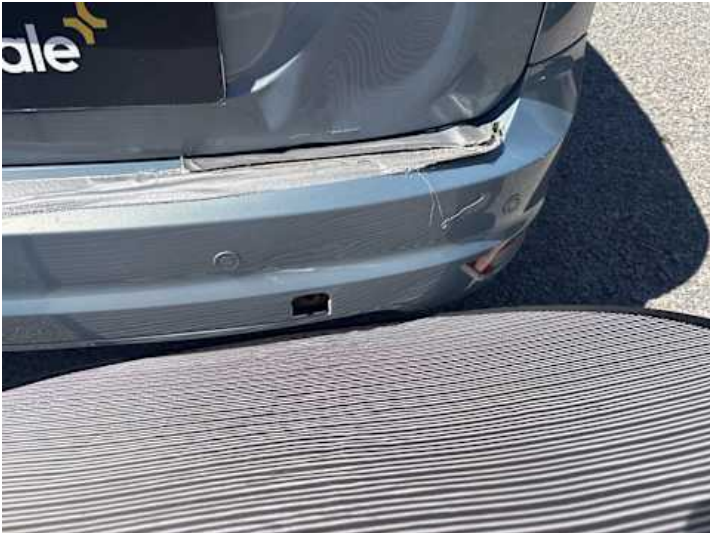
Stoßstange hinten (Kratzer, Verformung)
