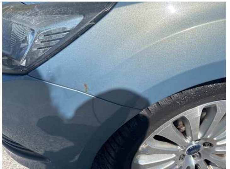
Kotflügel vorne links (Rost)
