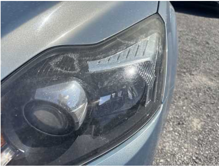
Scheinwerfer (links) (Anderer Schaden): Rissig
