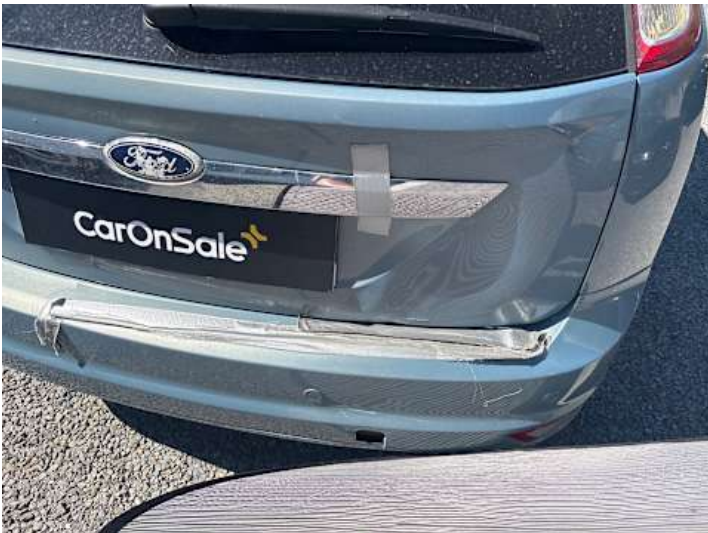
Heckklappe (Verformung, Riss/Bruch, Unsachgemäß instand gesetzt)
