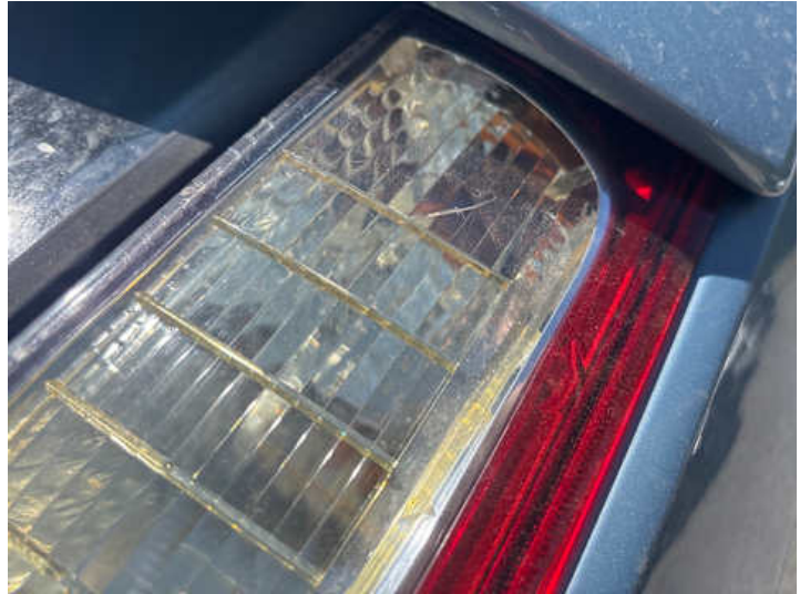
Rücklicht (rechts) (Riss/Bruch)
