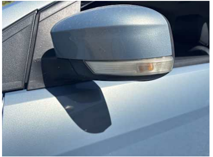
Fahrtür (Anderer Schaden): Blinker matt
