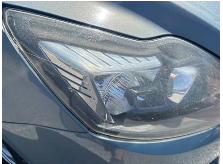
Scheinwerfer (rechts) (Anderer Schaden): Rissig
