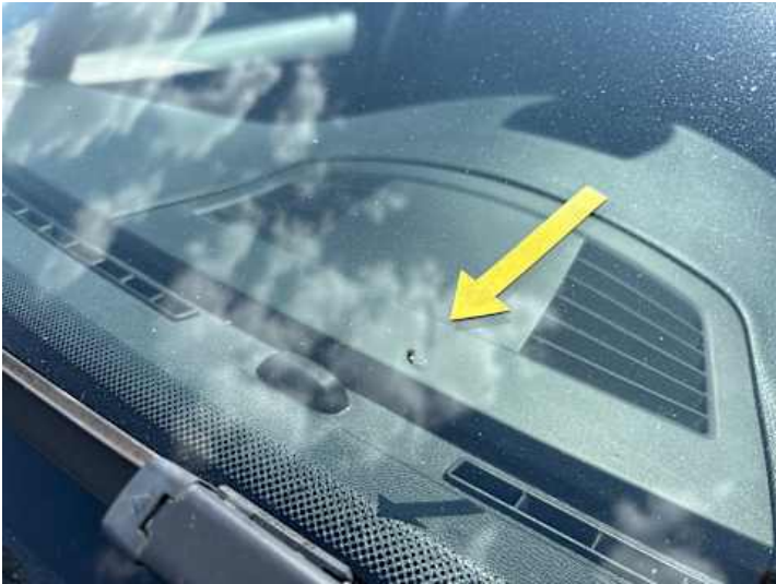
Windschutzscheibe (Riss/Bruch, Steinschlag)
