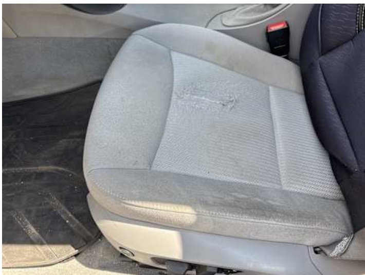
Innenraum (Riss/Bruch, Verschmutzung)
