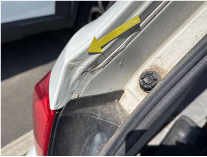
Seitenteil hinten links (Rost)
