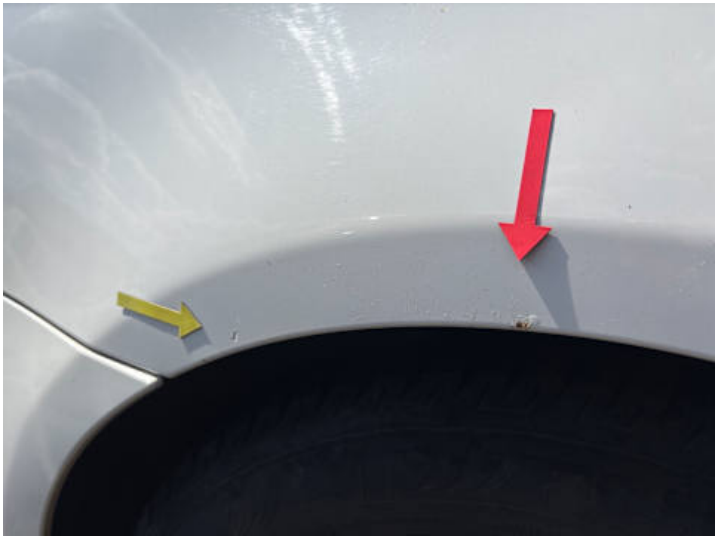
Seitenteil hinten rechts (Rost, Lackschaden)
