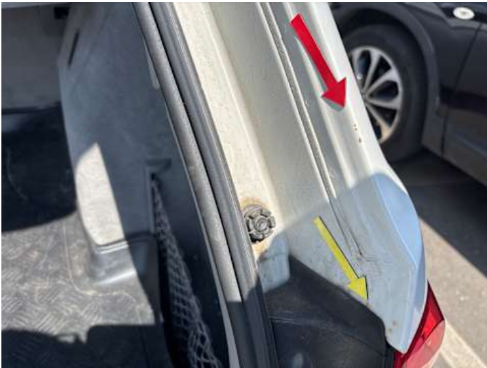
Seitenteil hinten rechts (Rost)
