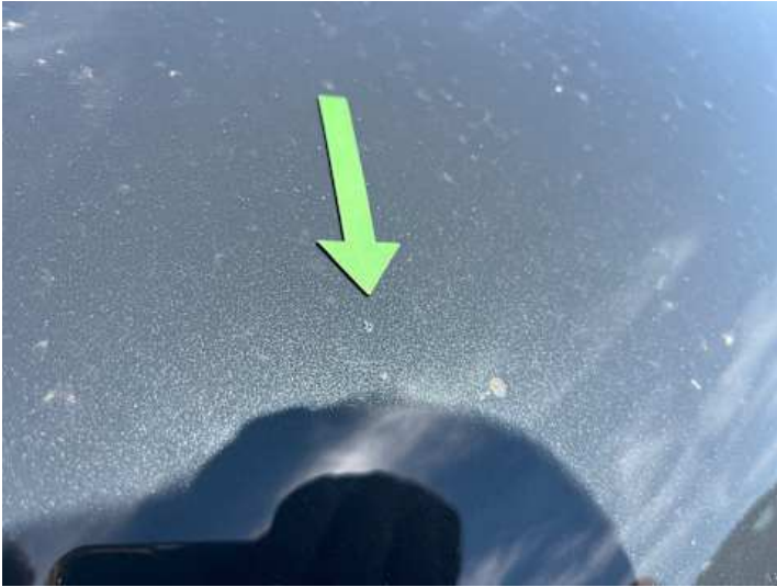
Motorhaube (Lackschaden, Steinschlag)
