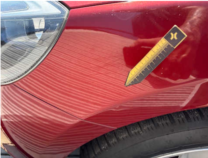
Kotflügel vorne links (Delle)
