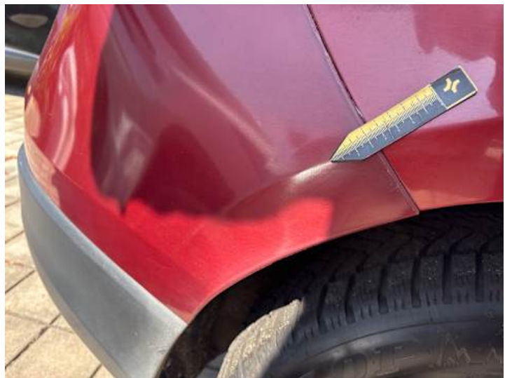
Stoßstange hinten (Verformung)
