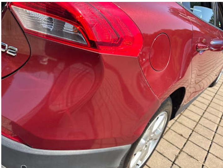
Stoßstange hinten (Anderer Schaden): Farbabweichungen
