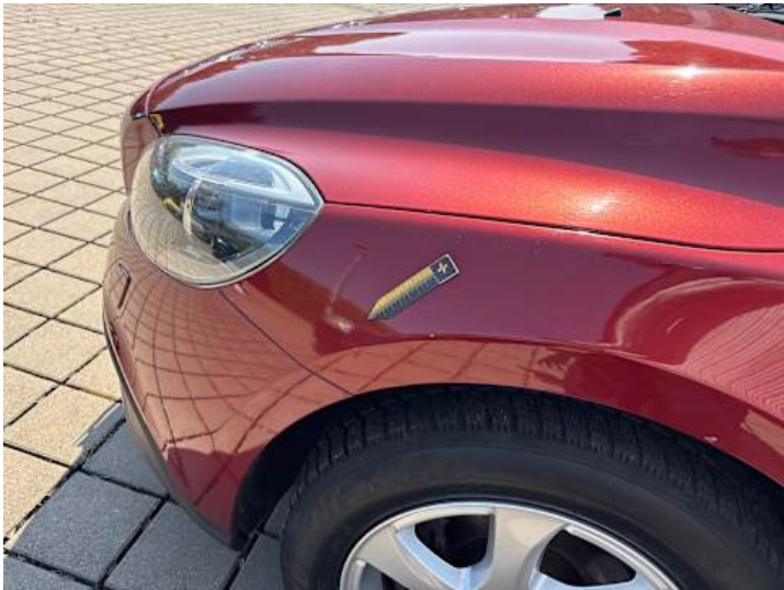
Kotflügel vorne links (Delle)
