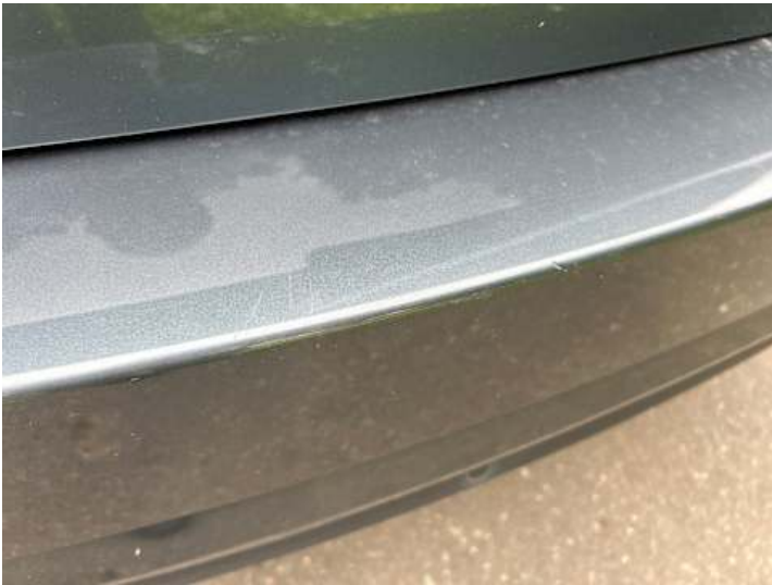
Stoßstange hinten (Kratzer, Riss/Bruch, Verformung)
