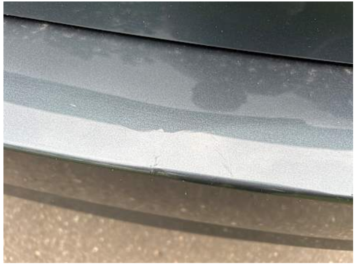
Stoßstange hinten (Kratzer, Riss/Bruch, Verformung)
