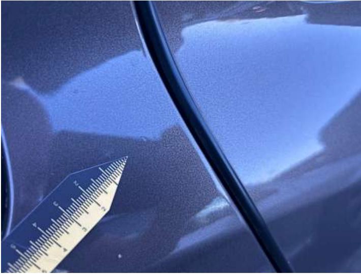
Seitenteil hinten rechts (Unsachgemäß instand gesetzt)
