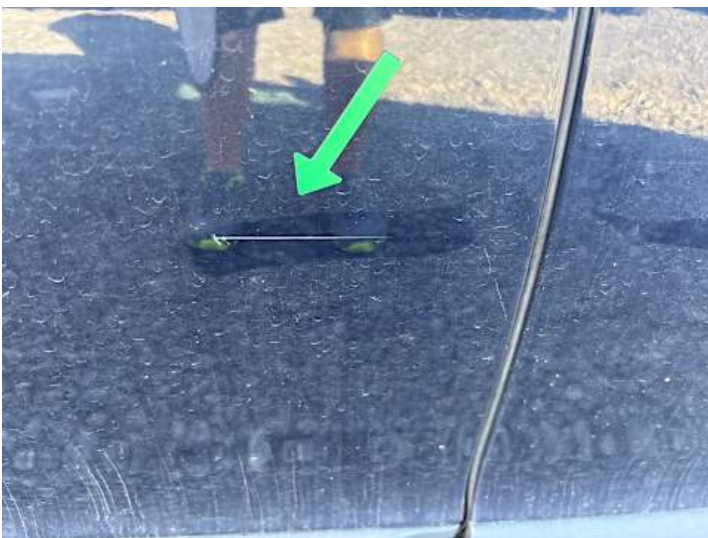
Türe hinten rechts (Kratzer)
