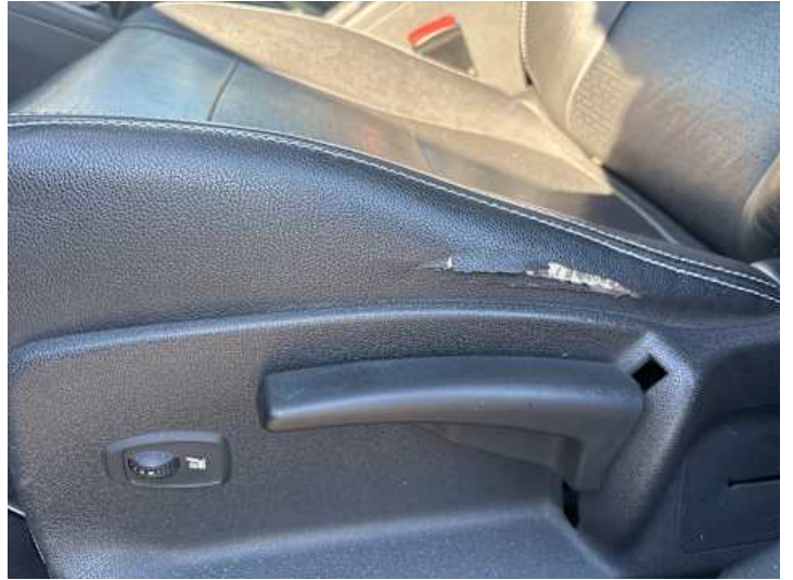
Innenraum (Verschleiß, Riss/Bruch)
