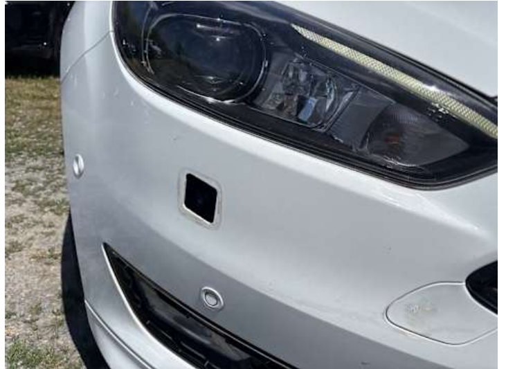
Stoßstange vorne (Anderer Schaden): Abdeckung fehlt
