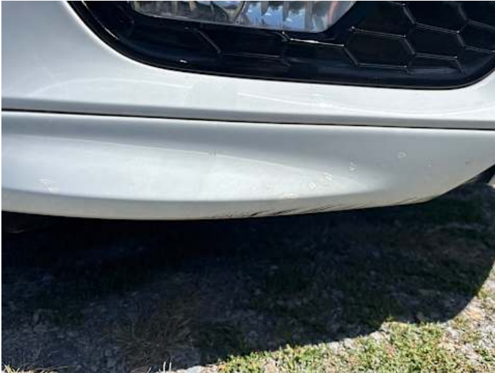
Stoßstange vorne (Unsachgemäß instand gesetzt, Kratzer)
