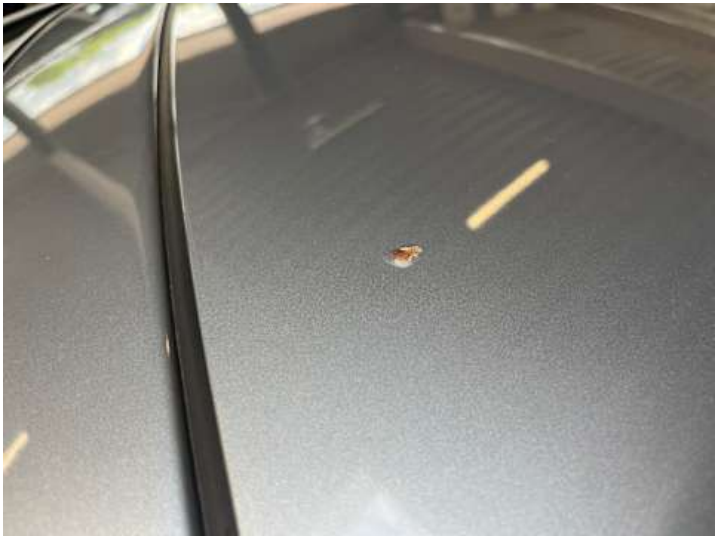
Dach (Lackschaden, Rost)
