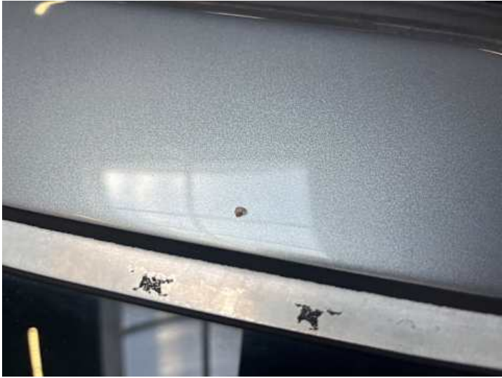
Dach (Lackschaden, Steinschlag)
