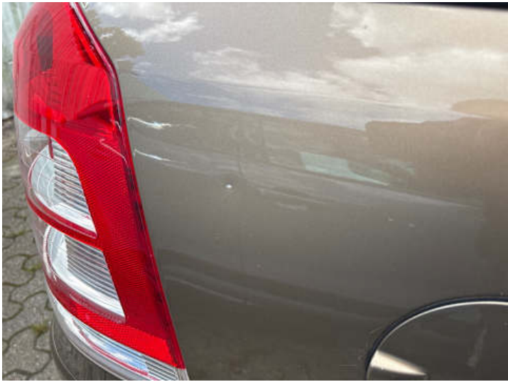
Seitenteil hinten rechts (Delle, Steinschlag)
