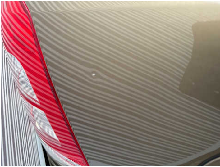
Seitenteil hinten rechts (Delle, Steinschlag)
