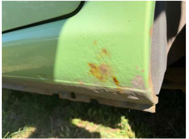
Schweller links (Rost)
