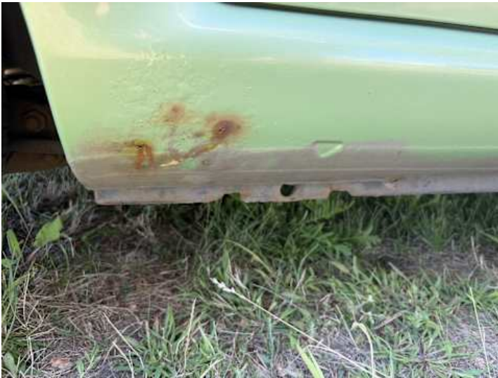
Schweller rechts (Rost)
