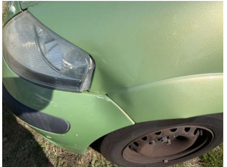
Kotflügel vorne links (Verformung)
