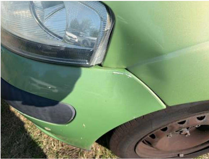
Stoßstange vorne (Verformung, Kratzer)
