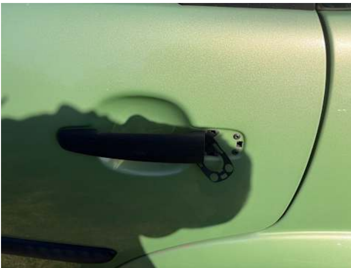
Türe hinten links (Anderer Schaden): Türgriff ohne Funktion
