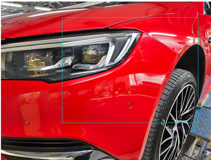
Bild 1: Außen, Stoßfänger vorne, Scheinwerfer, Kotflügel vorne links, Unfallschaden , Gutachten empfohlen/Mehrkosten möglich
