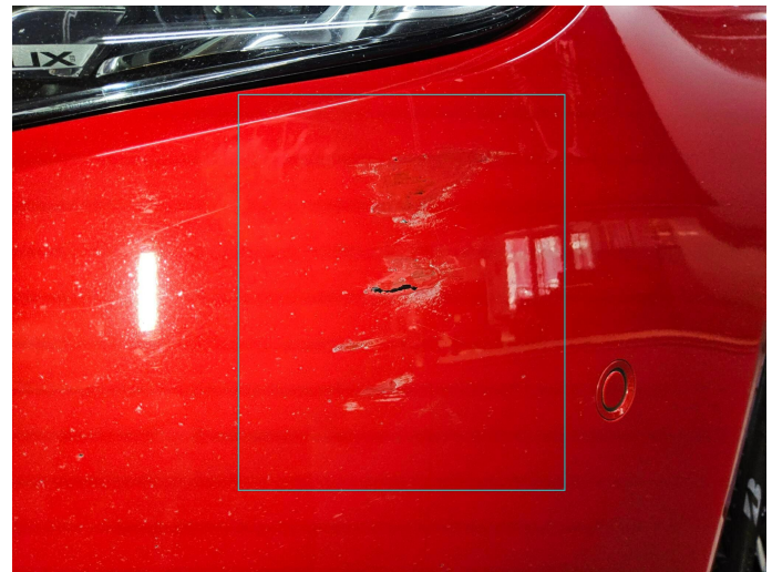
Bild 2: Außen, Stoßfänger vorne, Scheinwerfer, Kotflügel vorne links, Unfallschaden , Gutachten empfohlen/Mehrkosten möglich
