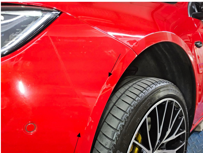
Bild 3: Außen, Stoßfänger vorne, Scheinwerfer, Kotflügel vorne links, Unfallschaden , Gutachten empfohlen/Mehrkosten möglich
