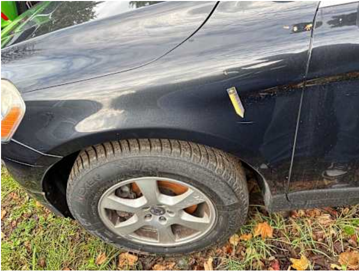
Kotflügel vorne links (Kratzer)
