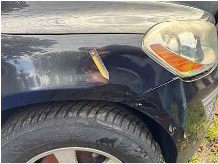
Kotflügel vorne rechts (Verformung, Lackschaden)
