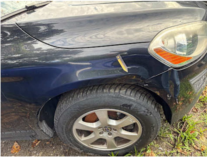
Kotflügel vorne rechts (Verformung, Lackschaden)
