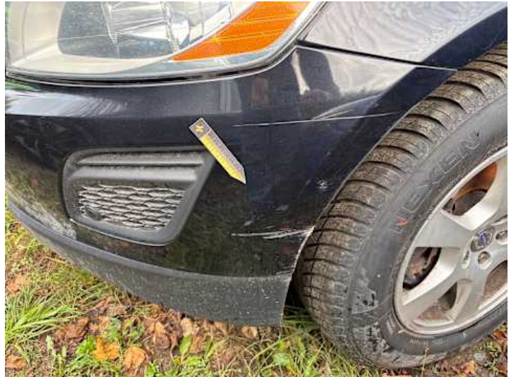
Stoßstange vorne (Verformung, Lackschaden, Spaltmaße ungenau)
