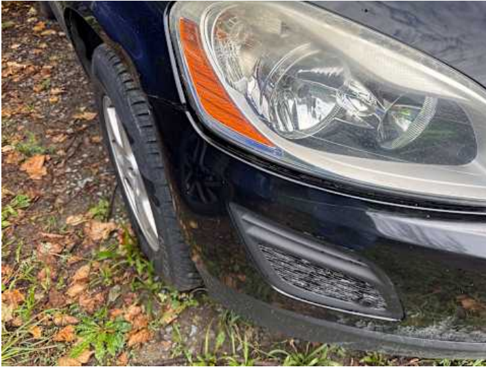
Stoßstange vorne (Verformung, Lackschaden, Spaltmaße ungenau)
