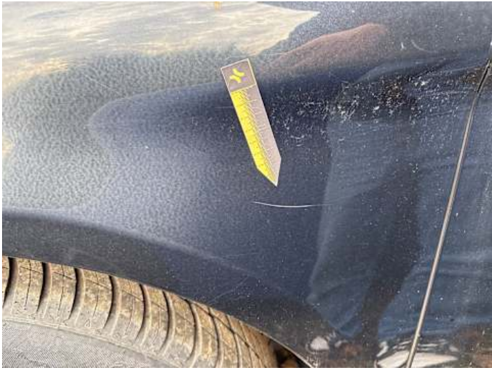
Kotflügel vorne links (Kratzer)
