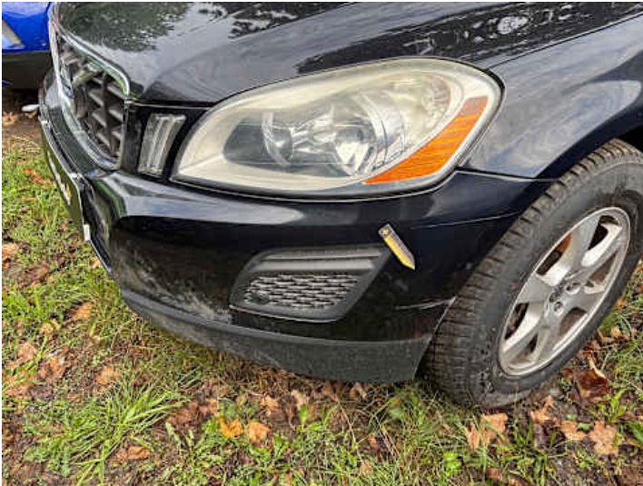
Stoßstange vorne (Verformung, Lackschaden, Spaltmaße ungenau)
