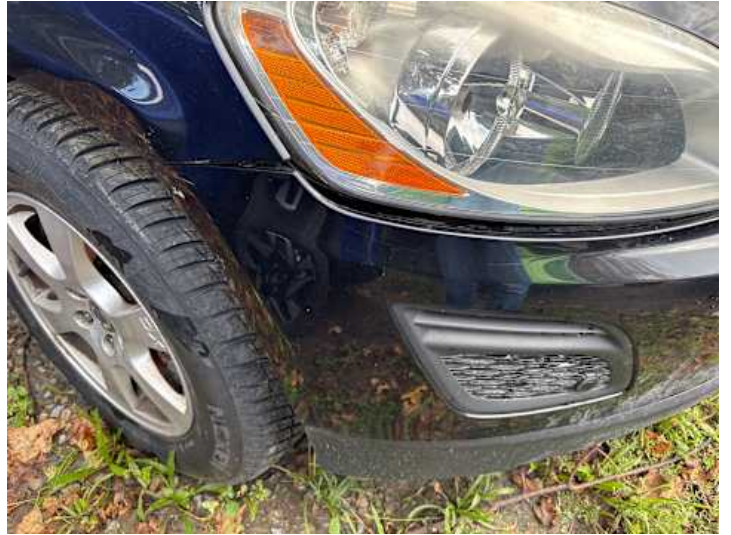
Stoßstange vorne (Verformung, Lackschaden, Spaltmaße ungenau)
