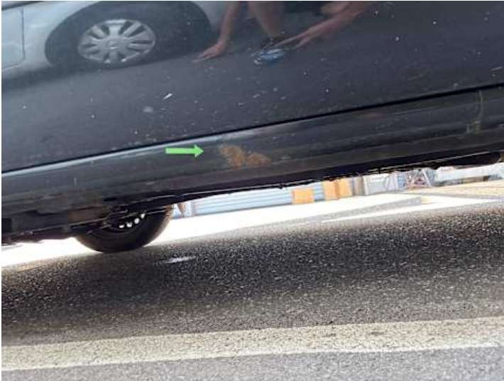
Schweller links (Rost)
