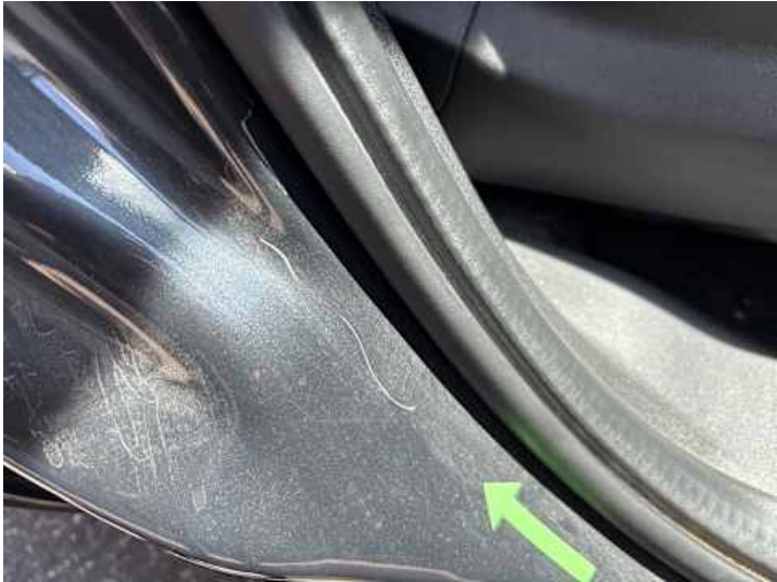
Schweller rechts (Kratzer)
