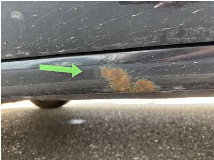
Schweller links (Rost)
