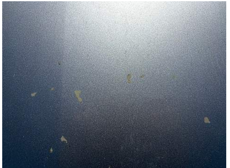
Motorhaube (Kratzer, Lackschaden, Unsachgemäß instand gesetzt, Delle)
