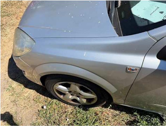
Kotflügel vorne links (Kratzer, Lackschaden, Unsachgemäß instand gesetzt)
