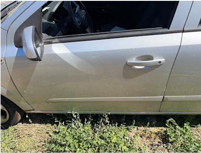
Fahrertür (Kratzer, Lackschaden, Delle)
