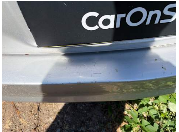
Stoßstange hinten (Kratzer, Lackschaden, Delle)
