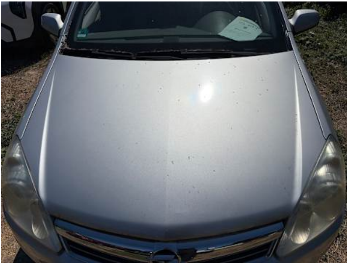
Motorhaube (Kratzer, Lackschaden, Unsachgemäß instand gesetzt, Delle)
