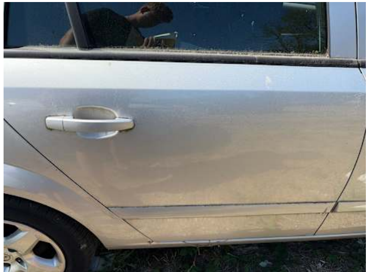
Türe hinten rechts (Kratzer, Lackschaden, Delle)
