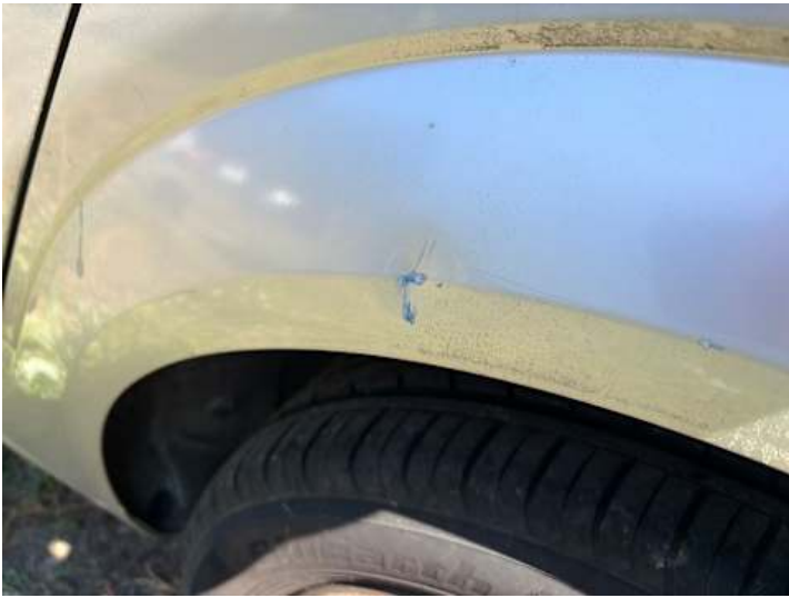
Seitenteil hinten links (Kratzer, Lackschaden, Delle)
