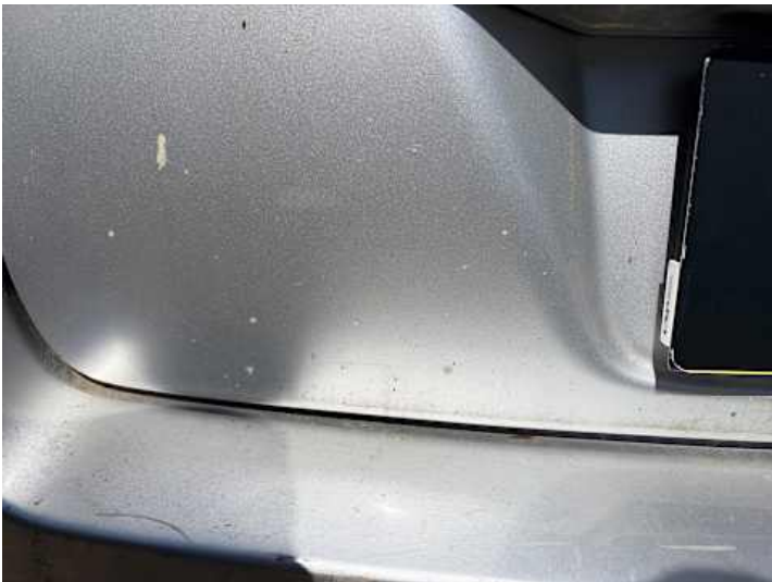
Heckklappe (Kratzer, Lackschaden)
