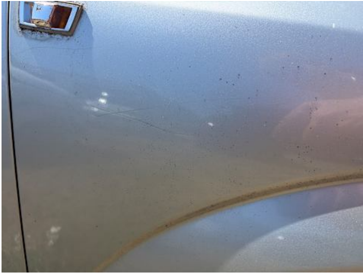
Kotflügel vorne rechts (Kratzer, Lackschaden)
