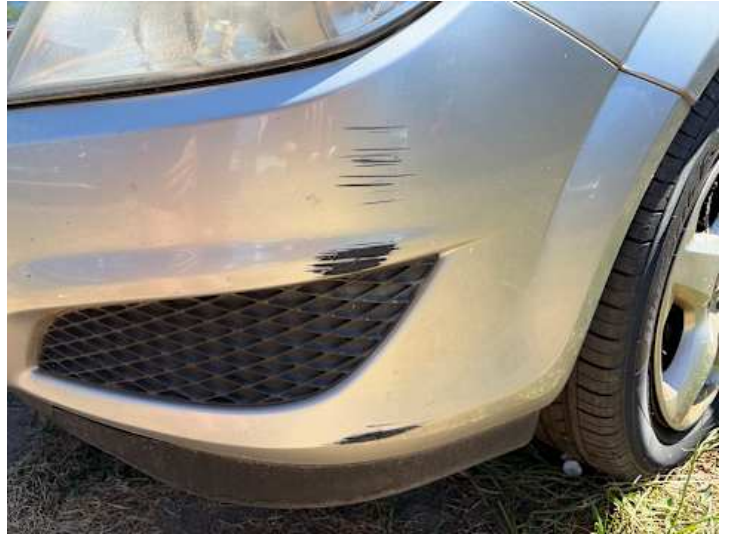
Stoßstange vorne (Kratzer, Lackschaden, Delle)
