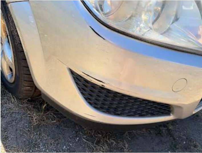
Stoßstange vorne (Kratzer, Lackschaden, Delle)
