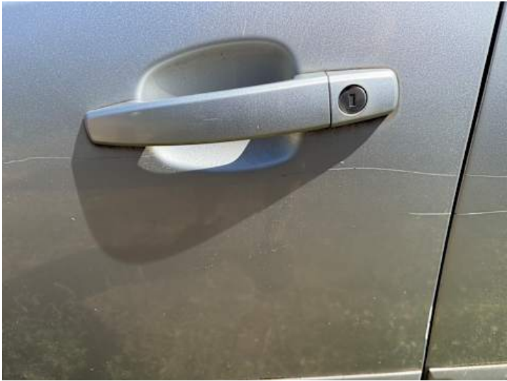
Fahrertür (Kratzer, Lackschaden, Delle)
