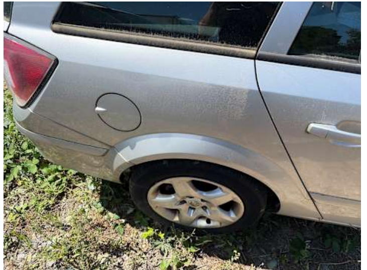
Seitenteil hinten rechts (Kratzer, Lackschaden, Delle)
