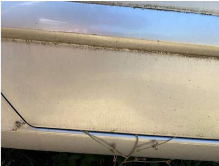
Türe hinten rechts (Kratzer, Lackschaden, Delle)
