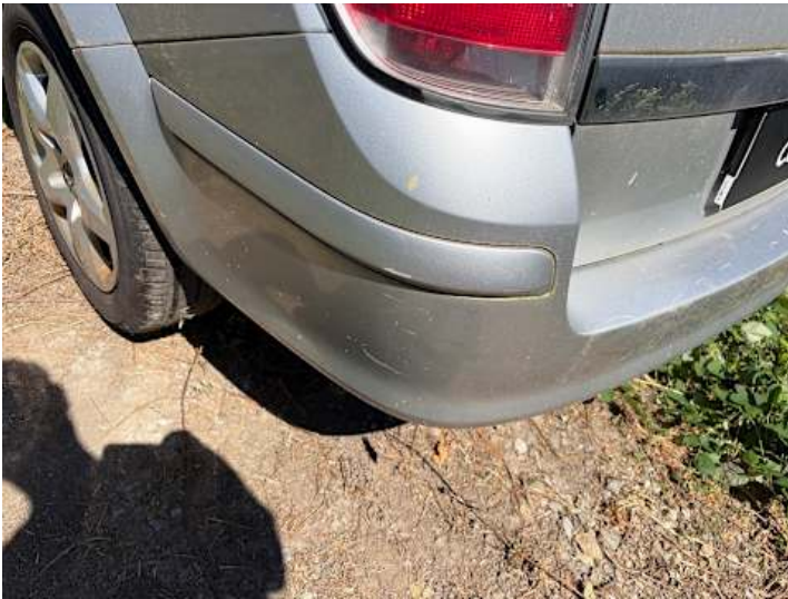
Stoßstange hinten (Kratzer, Lackschaden, Delle)
