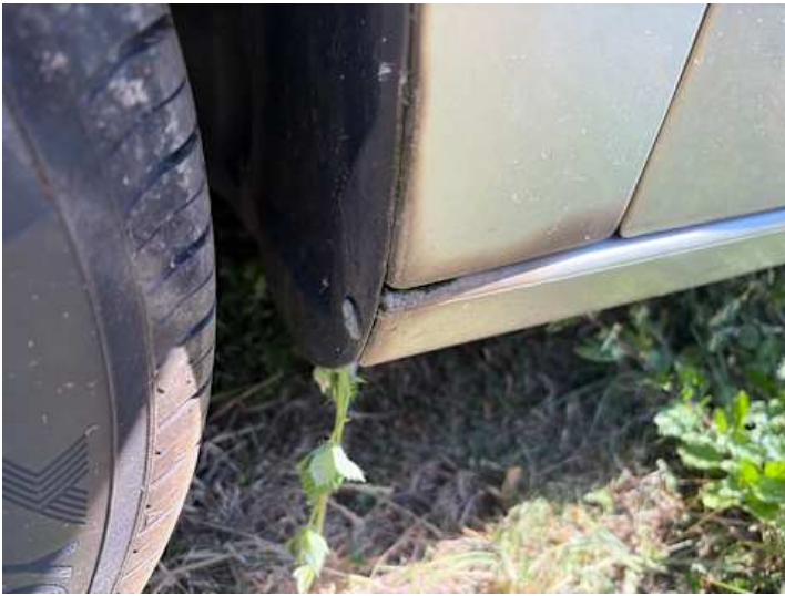
Schweller links (Rost)
