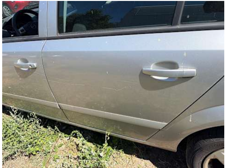
Türe hinten links (Kratzer, Lackschaden, Delle, Rost)
