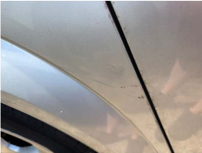
Seitenteil hinten rechts (Kratzer, Lackschaden, Delle)
