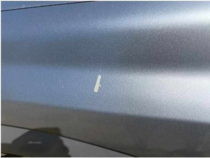
Kotflügel vorne links (Kratzer, Lackschaden, Unsachgemäß instand gesetzt)
