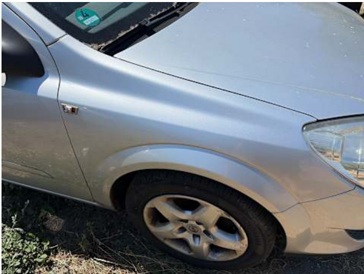
Kotflügel vorne rechts (Kratzer, Lackschaden)
