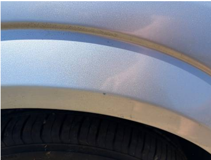
Kotflügel vorne rechts (Kratzer, Lackschaden)
