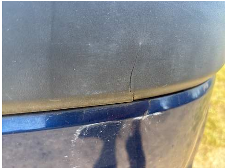
Stoßstange hinten (Kratzer, Riss/Bruch)
