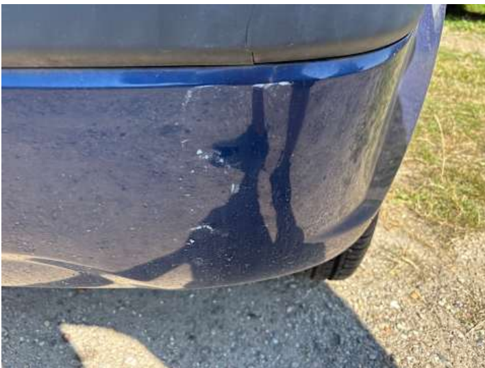
Stoßstange hinten (Kratzer, Riss/Bruch)
