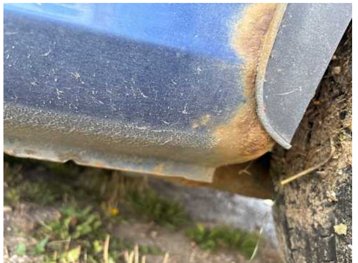
Schweller links (Rost)
