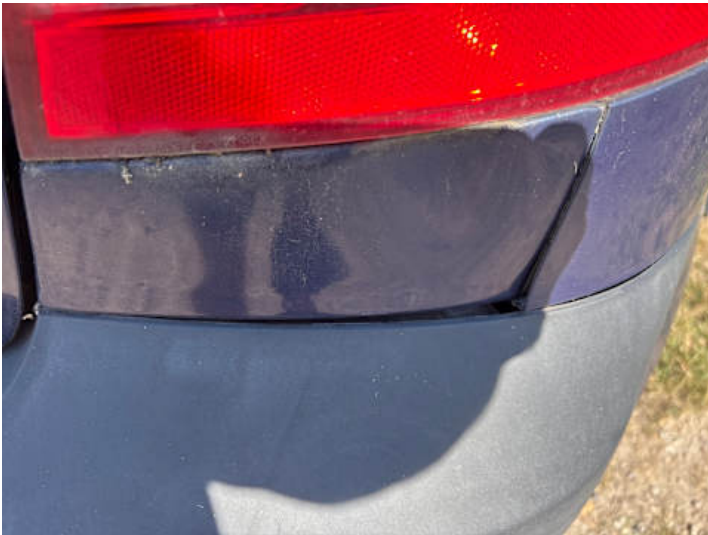
Stoßstange hinten (Kratzer, Riss/Bruch)
