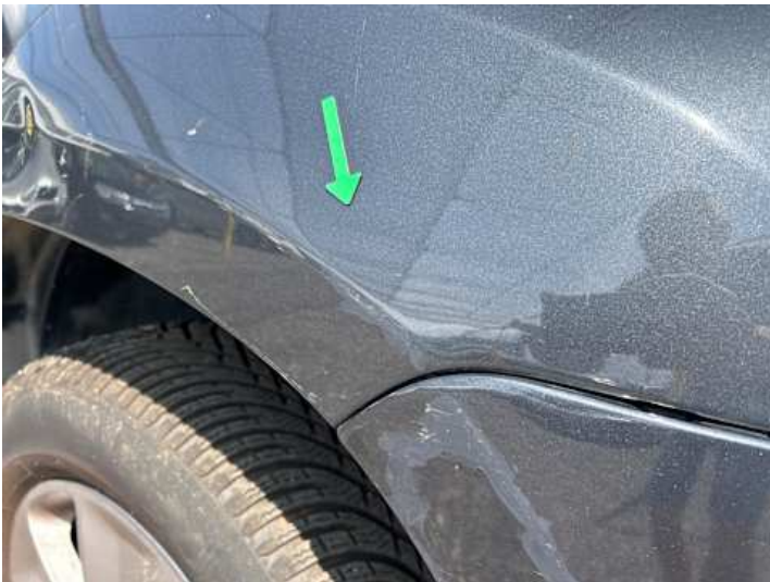
Kotflügel vorne rechts (Lackschaden)
