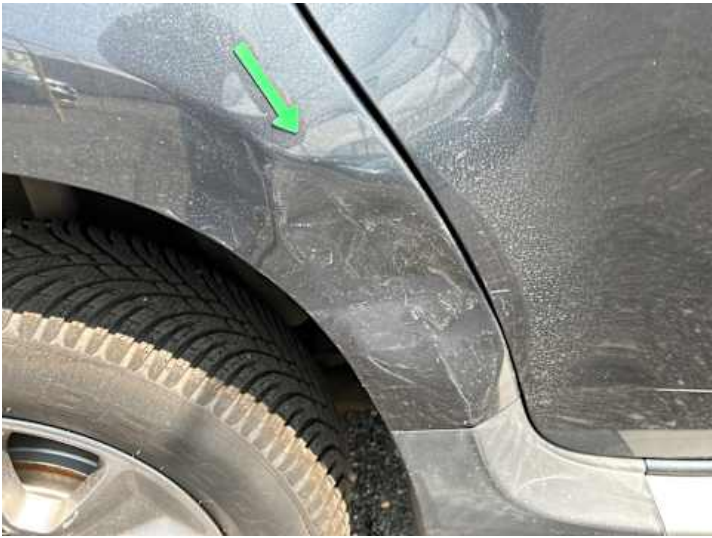
Seitenteil hinten rechts (Verformung, Lackschaden)
