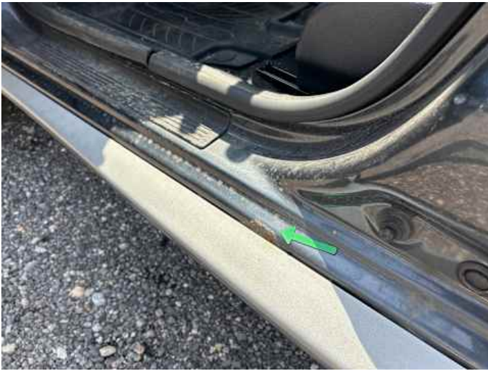
Schweller links (Rost)
