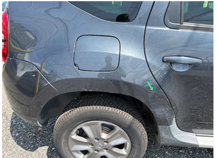
Seitenteil hinten rechts (Verformung, Lackschaden)
