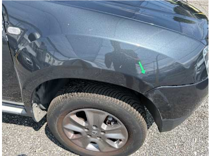
Kotflügel vorne rechts (Lackschaden)
