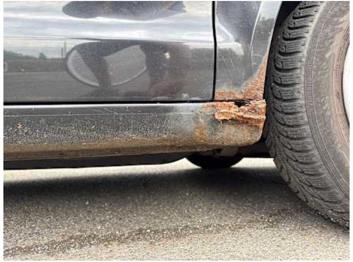
Schweller rechts (Rost)
