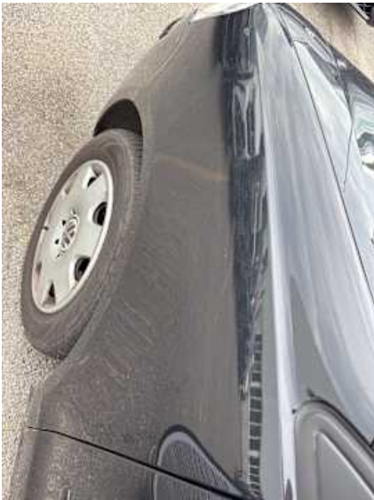
Kotflügel vorne links (Rost, Kratzer)
