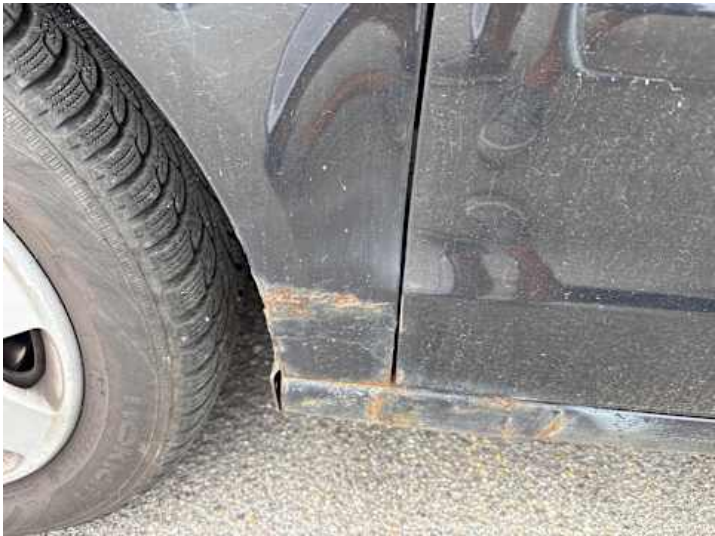
Kotflügel vorne links (Rost, Kratzer)
