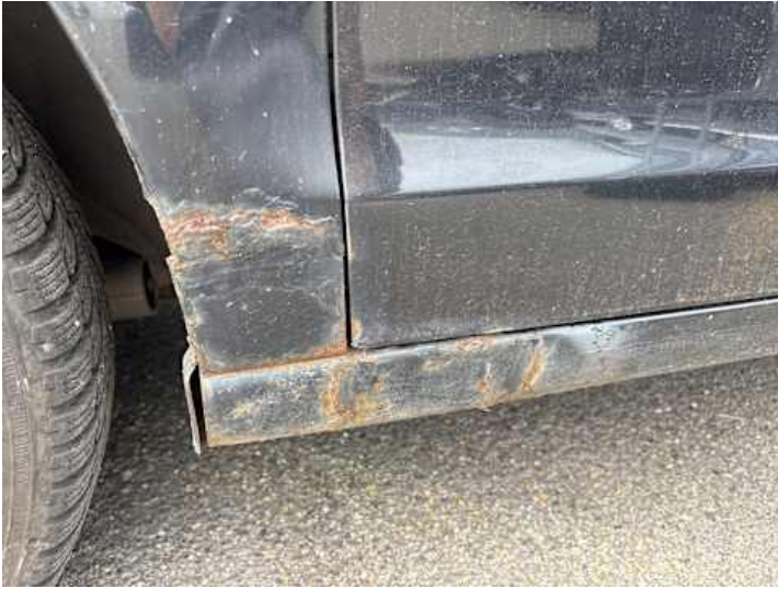
Schweller links (Rost)
