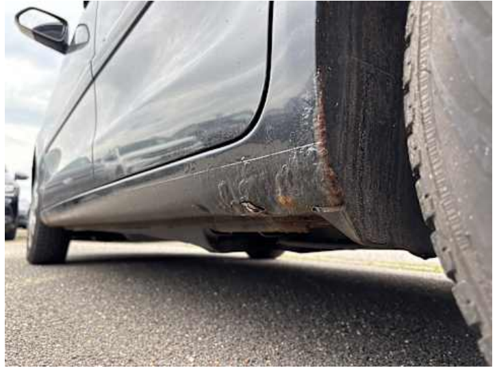
Schweller links (Rost)
