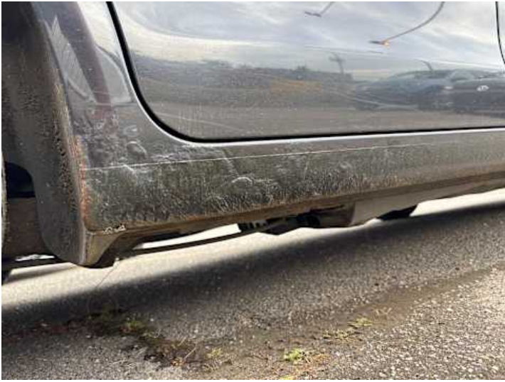
Schweller rechts (Rost)
