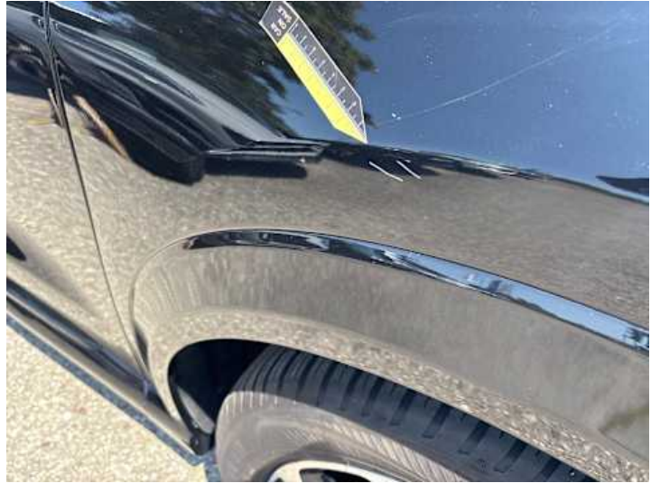
Kotflügel vorne rechts (Kratzer, Lackschaden)
