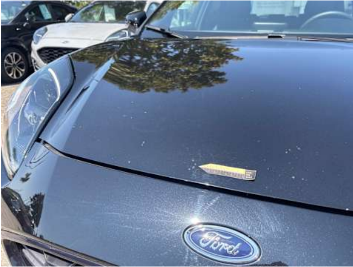
Motorhaube (Steinschlag, Lackschaden, Unsachgemäß instand gesetzt)
