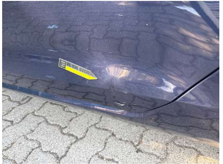
Türe hinten links (Kratzer, Verformung)
