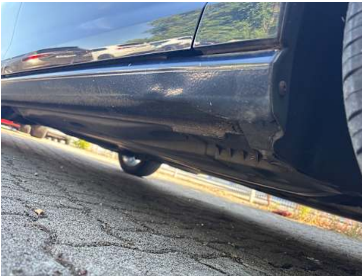
Schweller rechts (Verformung)
