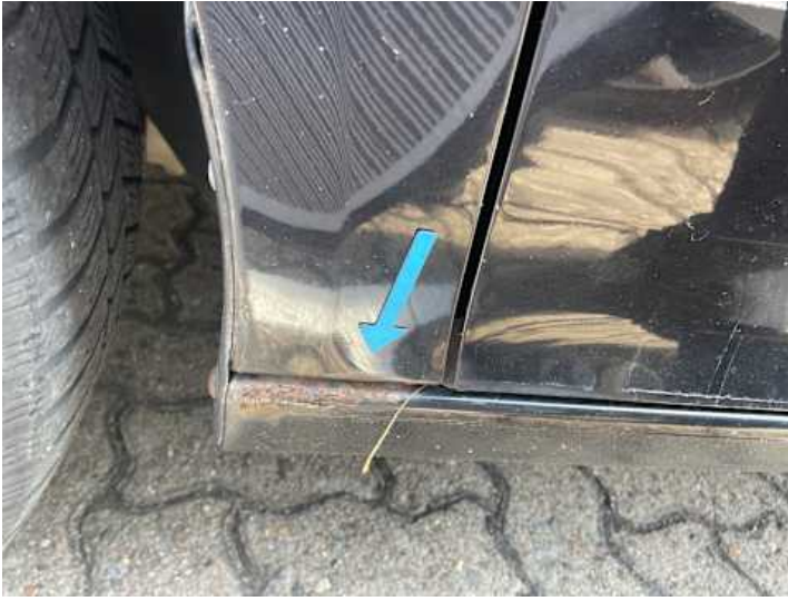
Schweller links (Rost)
