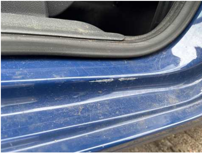
Schweller links (Lackschaden)
