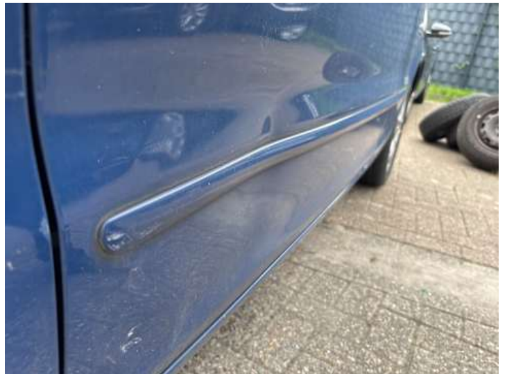
Fahrtür (Lackschaden, Verformung, Spaltmaße ungenau)
