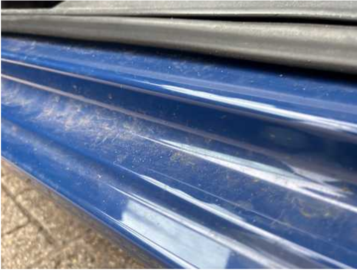
Schweller links (Rost, Lackschaden)
