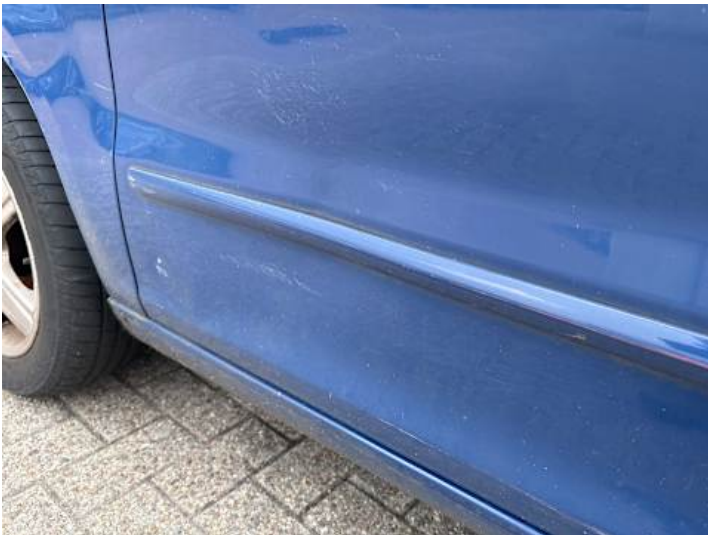
Fahrtür (Lackschaden, Verformung, Spaltmaße ungenau)
