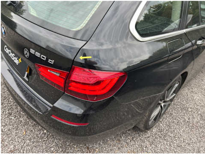
Seitenteil hinten rechts (Verformung, Lackschaden)
