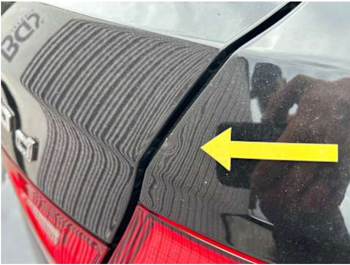
Seitenteil hinten rechts (Verformung, Lackschaden)
