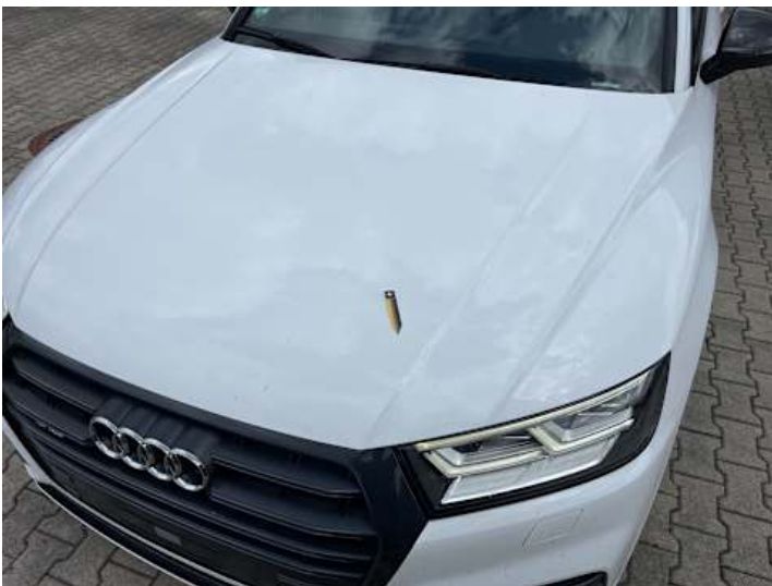
Motorhaube (Steinschlag, Lackschaden)
