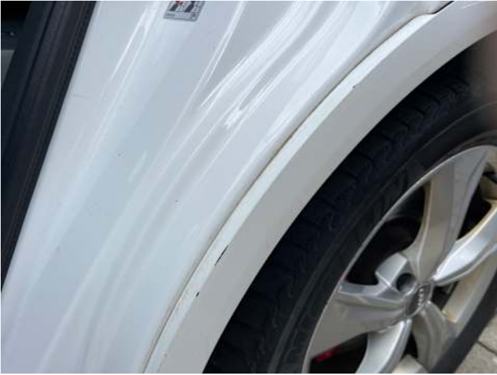
Seitenteil hinten links (Lackschaden)
