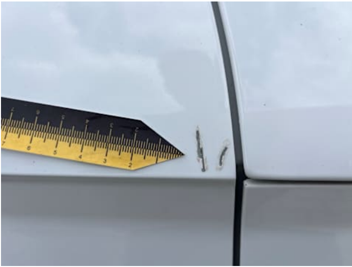
Beifahrertür (Lackschaden, Kratzer, Unsachgemäß instand gesetzt)
