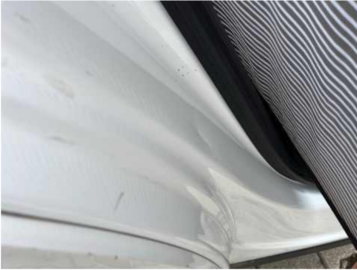
Türe hinten rechts (Delle)
