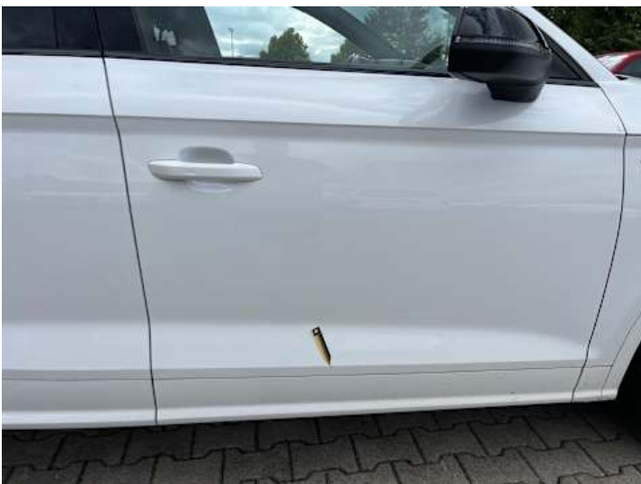
Beifahrertür (Lackschaden, Kratzer)
