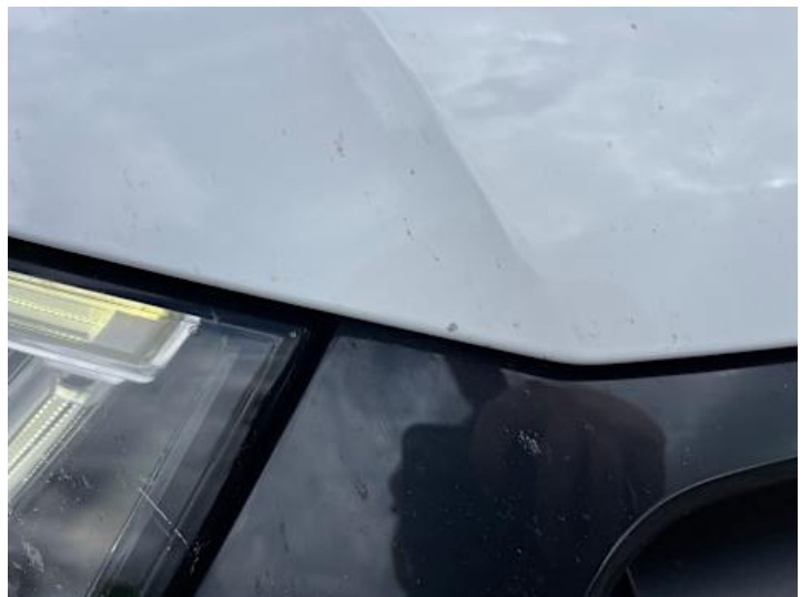
Motorhaube (Steinschlag, Lackschaden)
