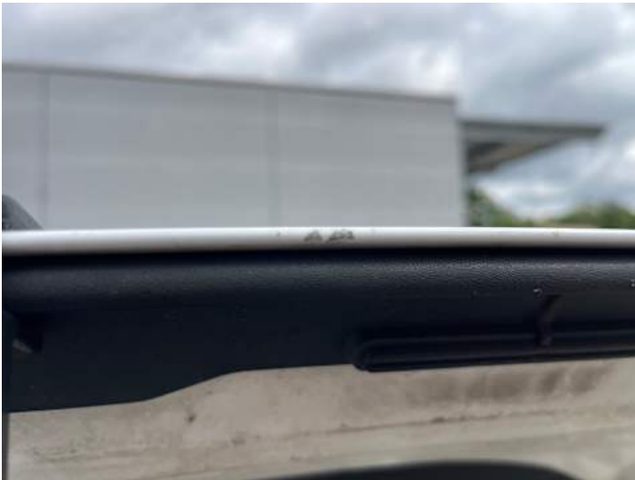
Motorhaube (Steinschlag, Lackschaden)
