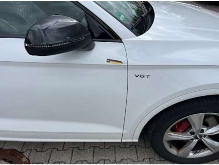
Beifahrertür (Lackschaden, Kratzer, Unsachgemäß instand gesetzt)
