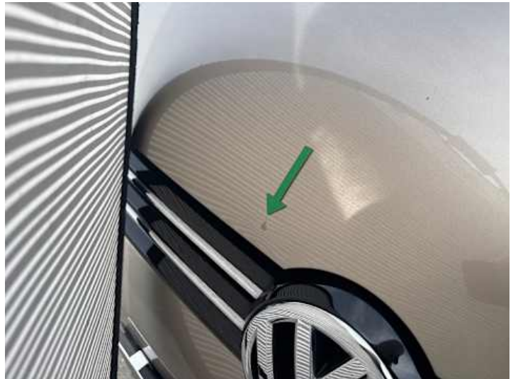
Motorhaube (Verformung, Rost, Steinschlag)
