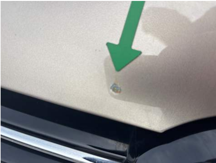
Motorhaube (Verformung, Rost, Steinschlag)
