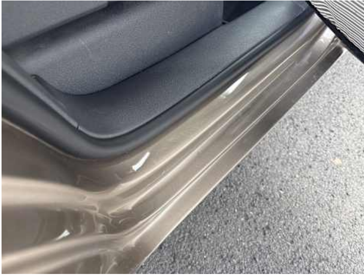
Schweller rechts (Verformung)
