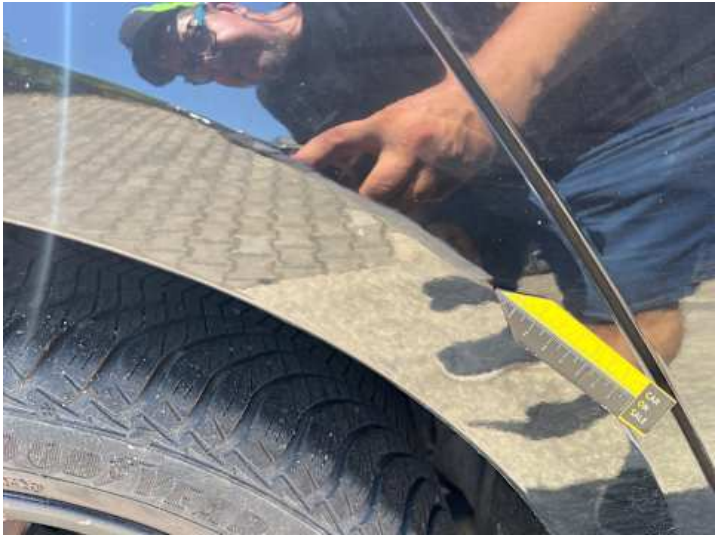
Seiten ­ teil hinten rechts (Kratzer, Lackschaden)
