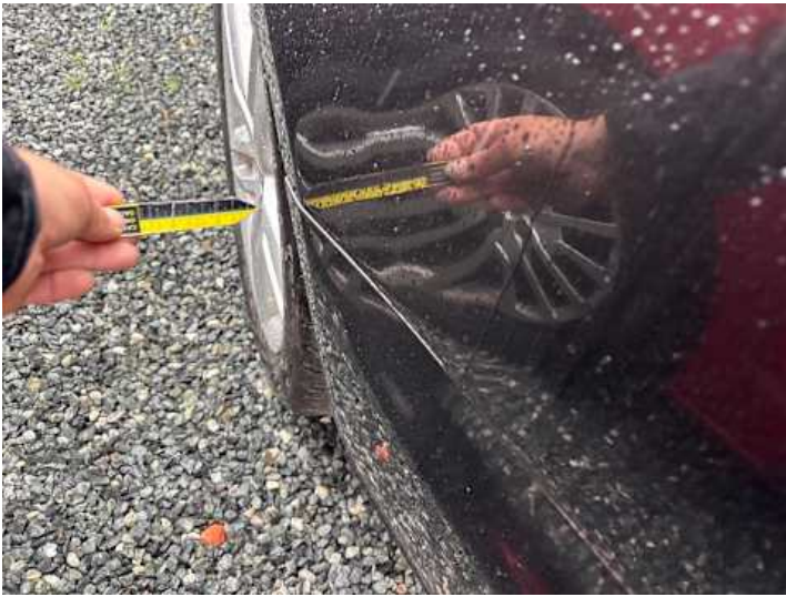
Stoßstange hinten (Spaltmaße ungenau)
