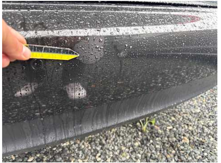
Stoßstange hinten (Riss/Bruch)
