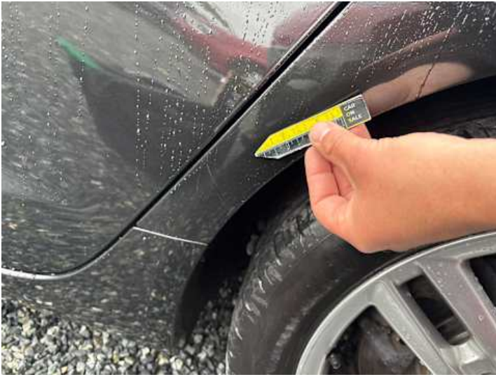
Seitenteil hinten links (Lackschaden)
