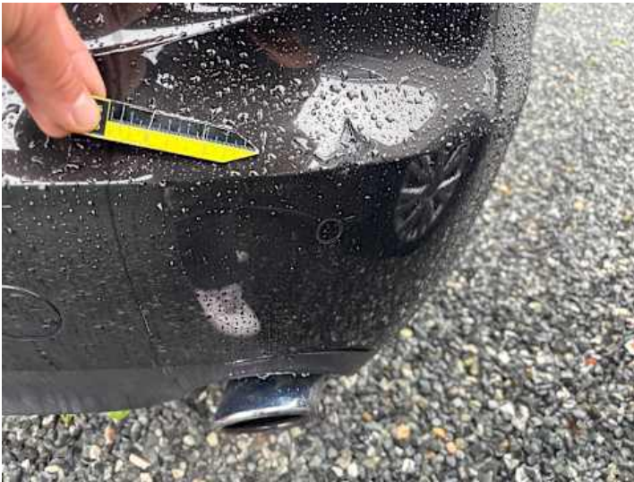
Stoßstange hinten (Riss/Bruch)
