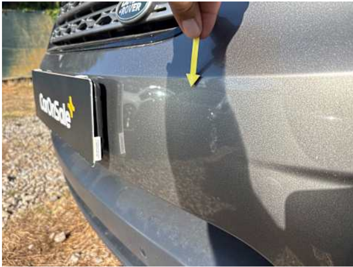
Stoßstange vorne (Steinschlag)
