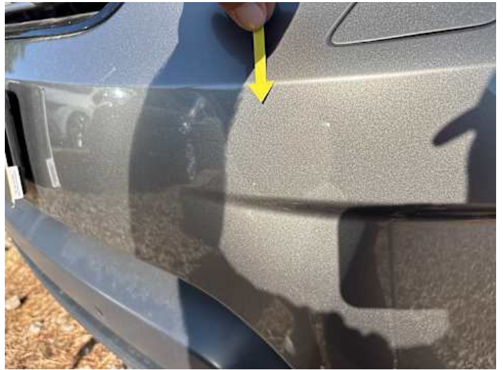
Stoßstange vorne (Steinschlag)
